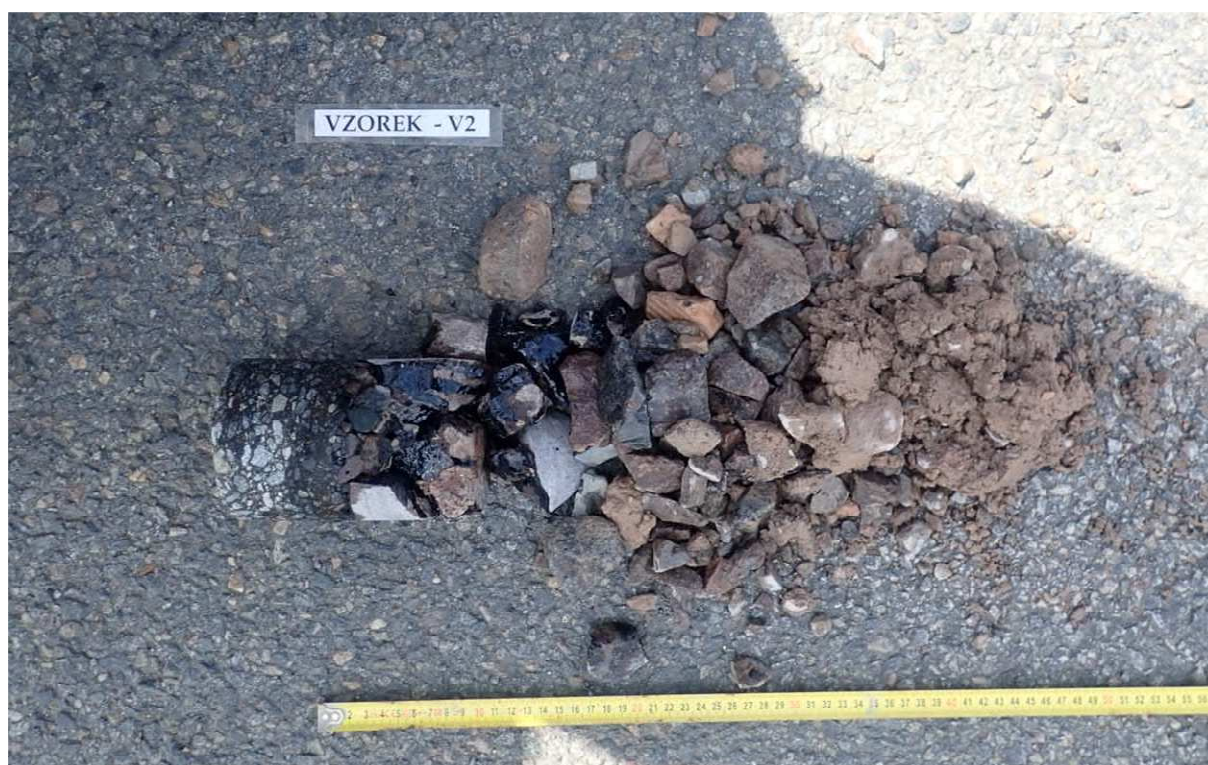
Obr. 3 - Jádro vývrtu Vzorek – V2 (in situ).
