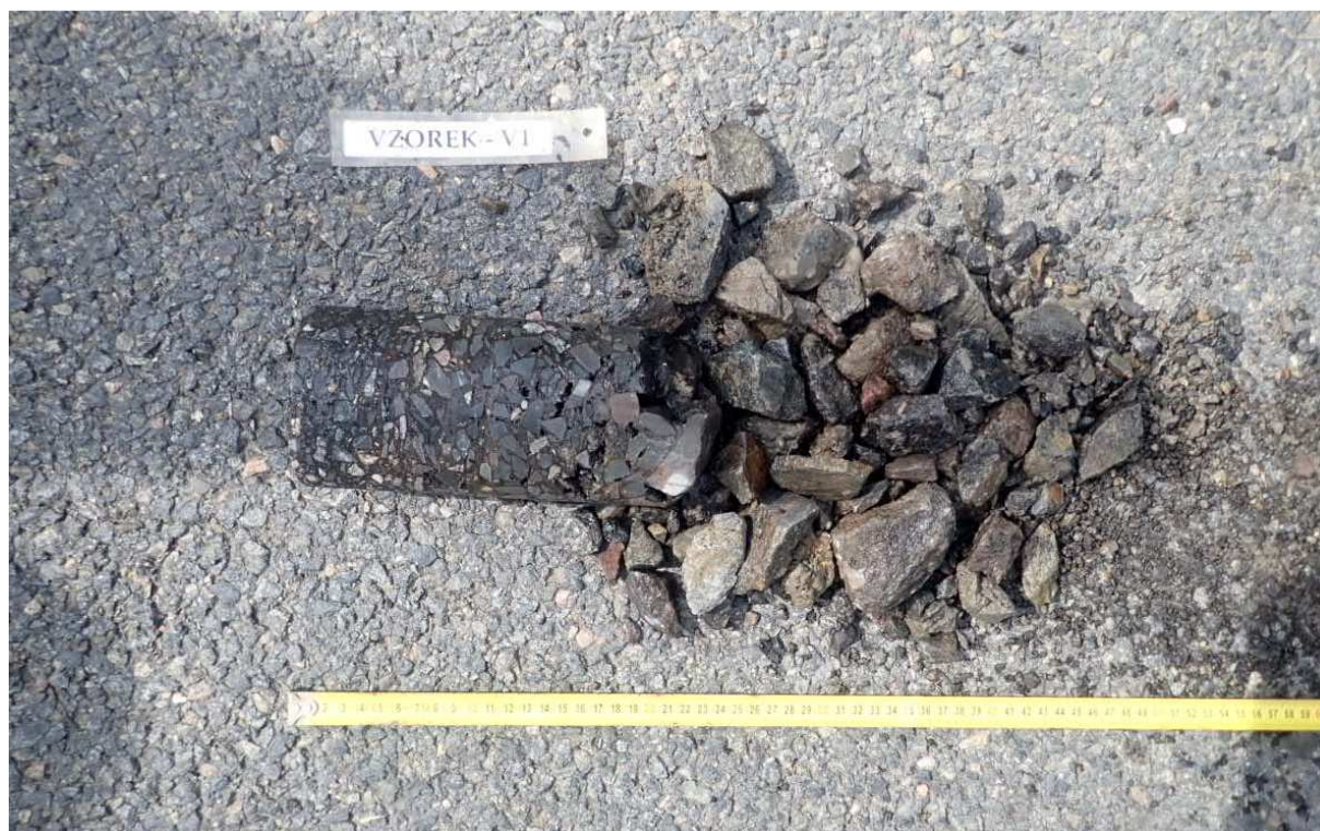
Obr. 1 - Jádro vývrtu Vzorek – V1 (in situ).
