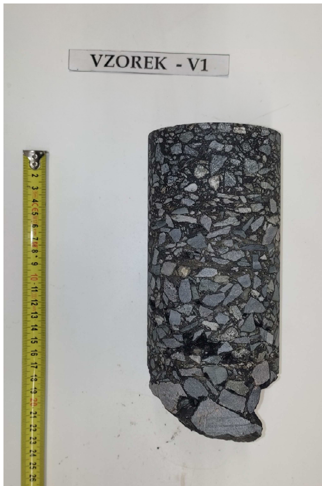
Obr. 2 - Jádru vývrtu Vzorek – V1 (laboratoř).
