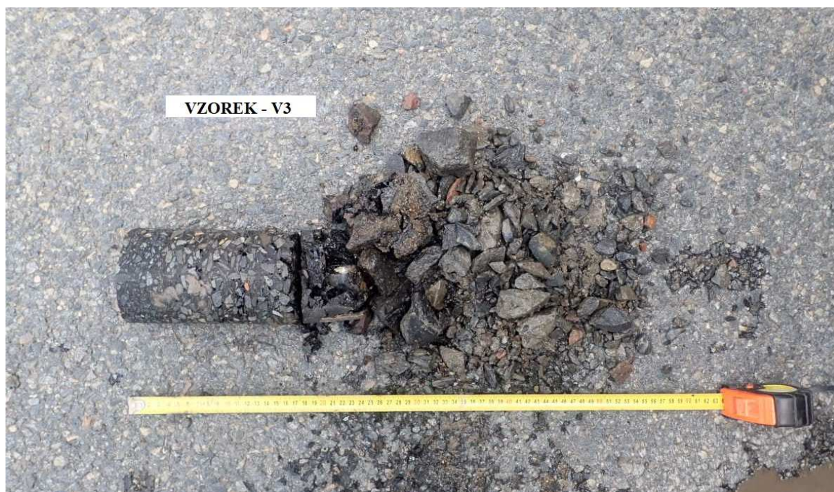
Obr. 5 - Jádro vývrtu Vzorek – V3 (in situ).
