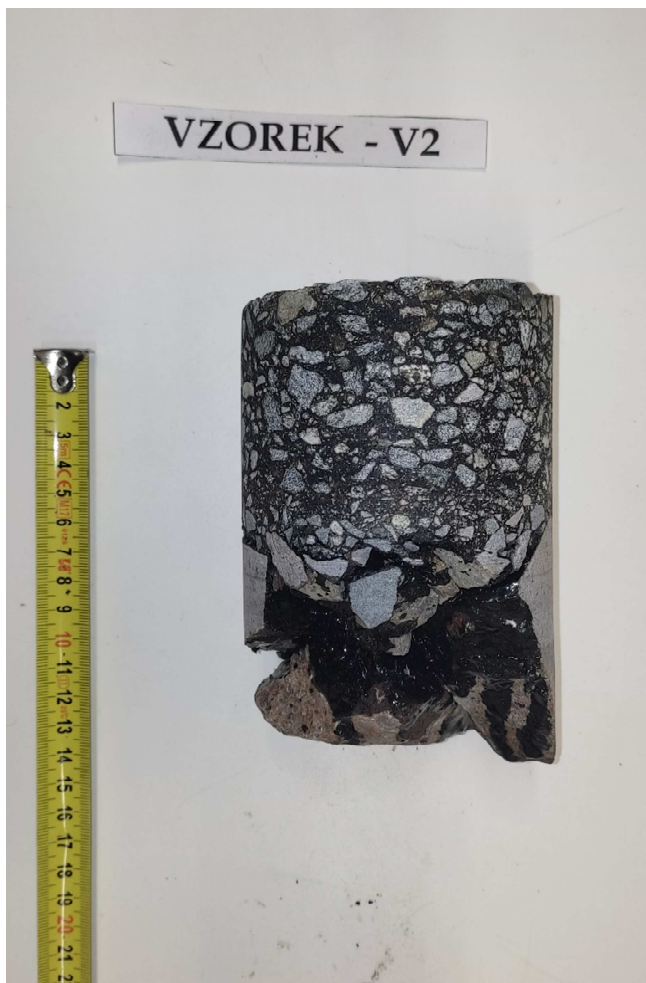
Obr. 4 - Jádru vývrtu Vzorek – V2 (laboratoř).
