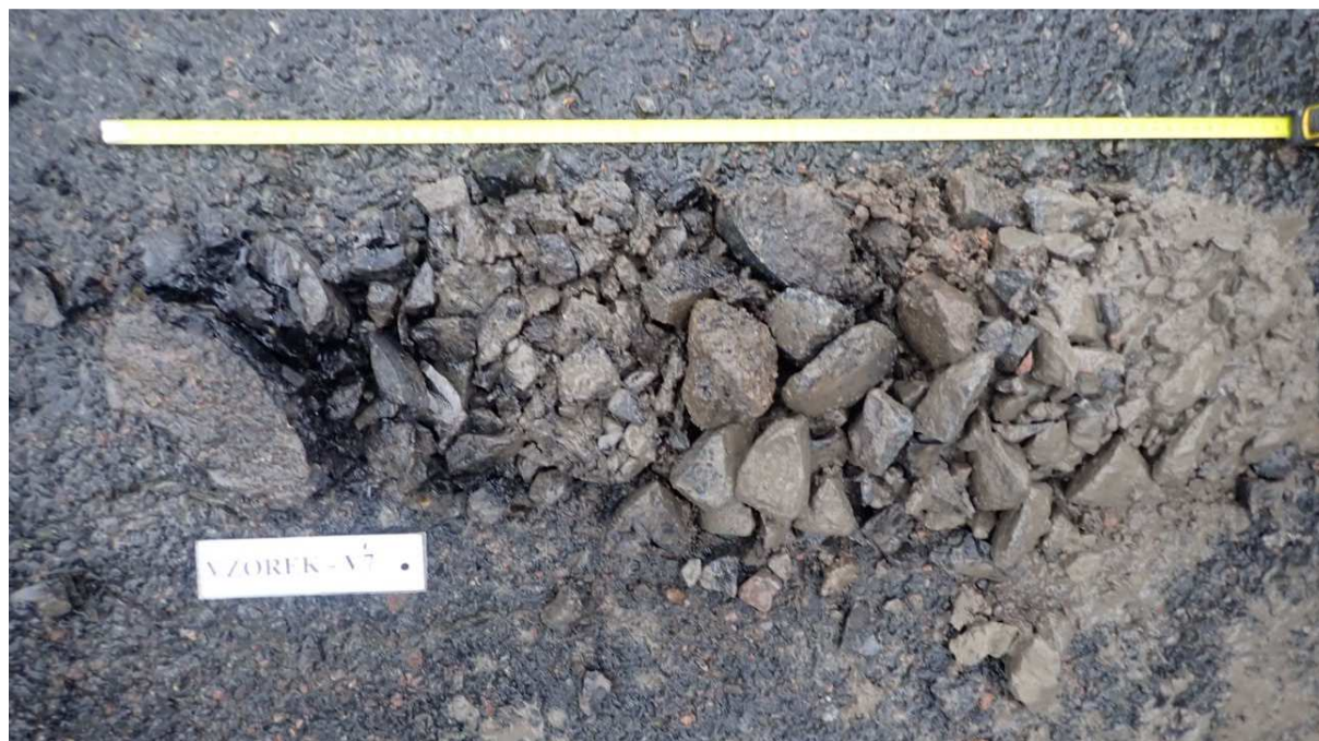
Obr. 1 - Jádro vývrtu Vzorek – V7 (in situ).
