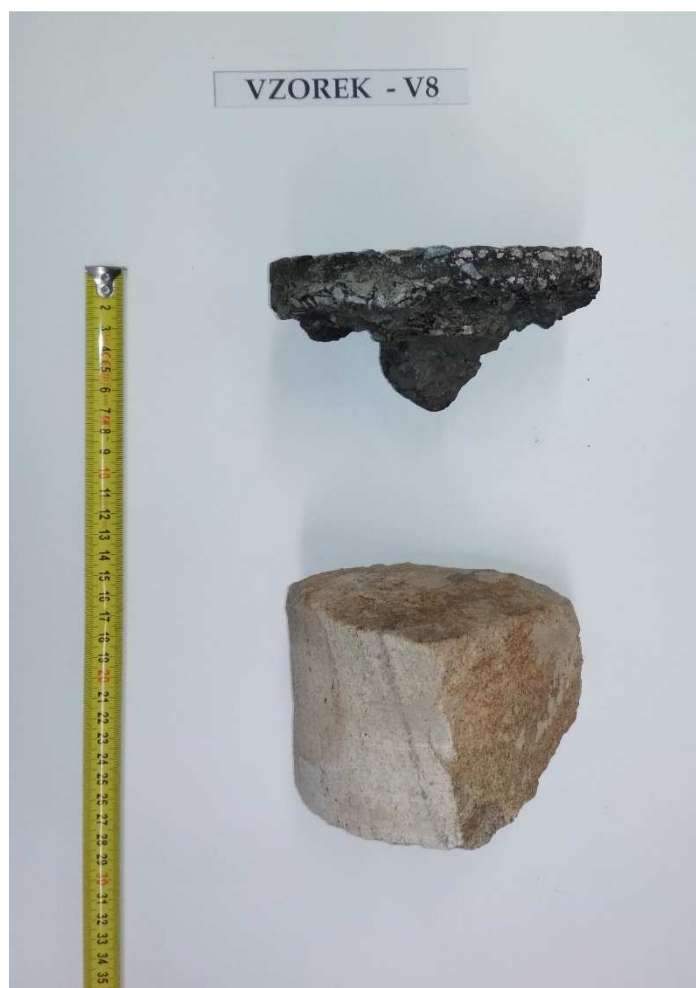
Obr. 4 - Jádro vývrtu Vzorek – V8 (laboratoř).
