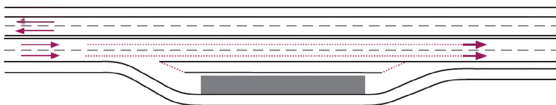
Obrázek 10 Autobusová (trolejbusová) zastávka mimo jízdni pruh (fyzicky oddělená) - Typ I
