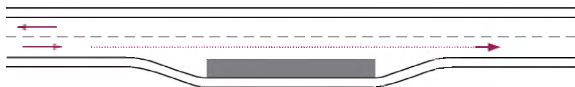
Obrázek 11 Autobusová (trolejbusová) zastávka mimo jízdniému pruh (bez fyzického oddělení - zálivová zastávka) - Typ II
