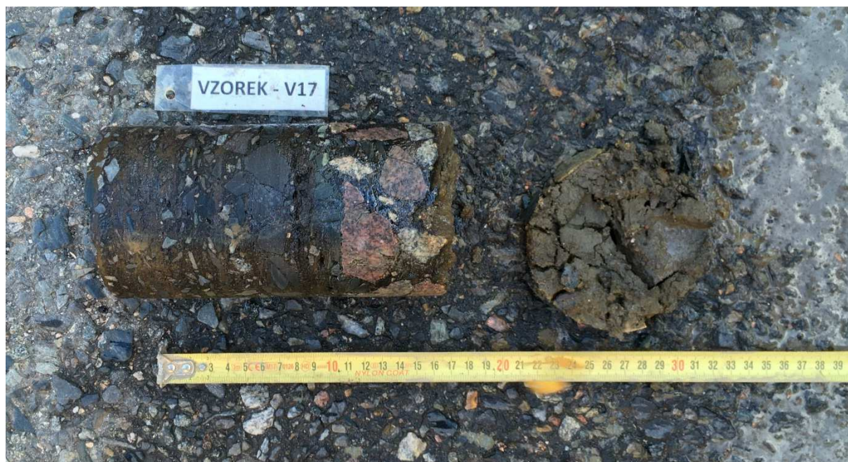
Obr. 1 - Jádro výtvetu Vzorek – V17 (in situ).
