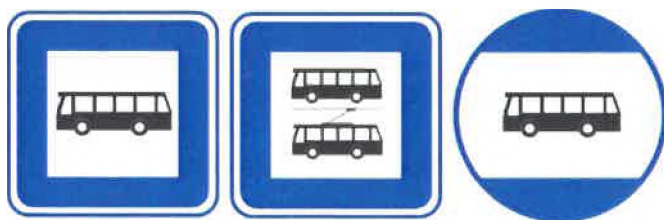
Obrázek 3 Svislé dopravní značky „Označník zastávky,, IJ 4a a IJ 4b se symbolem dopravního prostředku
