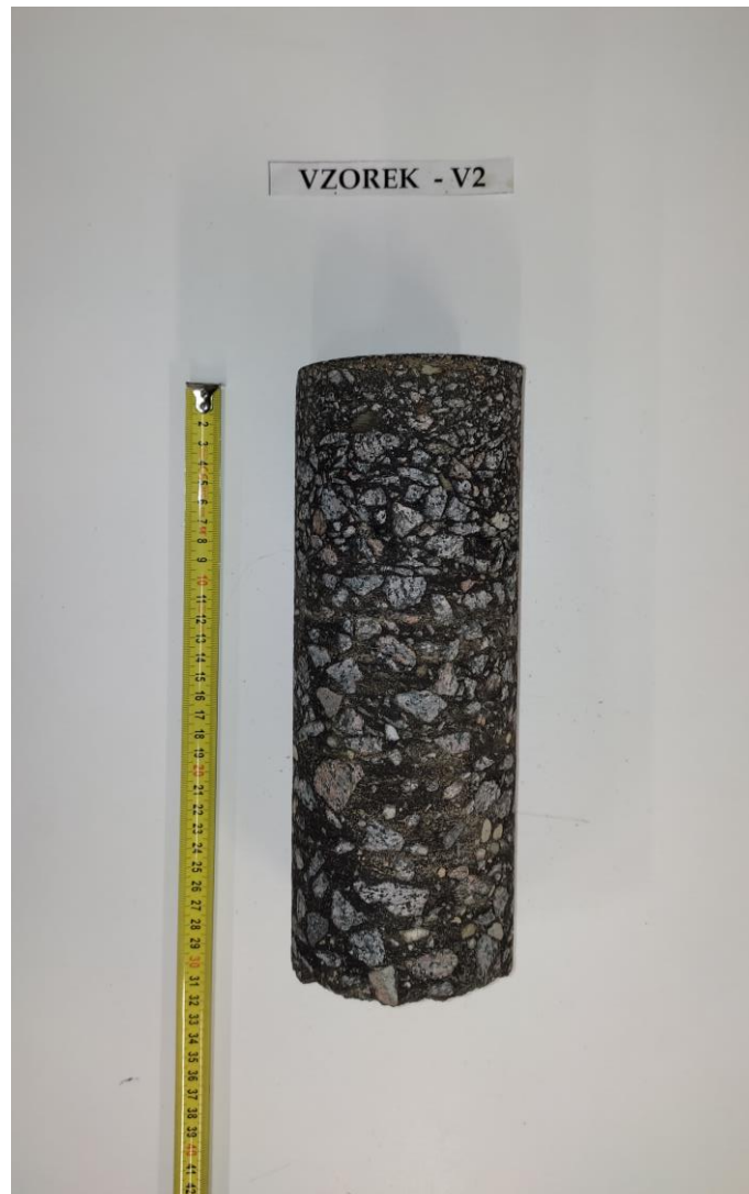
Obr. 4 - Jádro vývrtu Vzorek – V2 (laboratoř).
