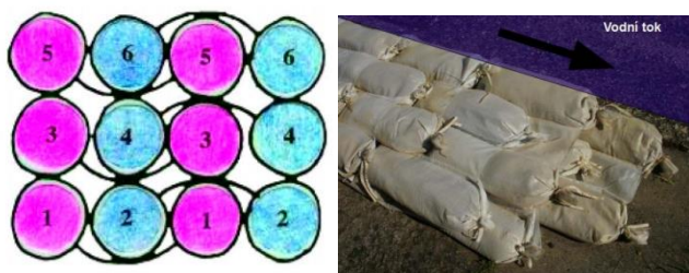
Obrázek 1. Kladení dvoukomorových pytlů [1]
