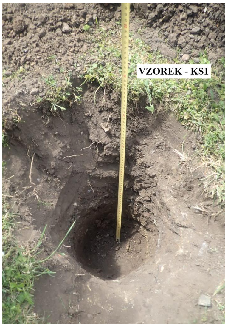
Obr. 1 – Kopaná sonda – KS1 (in situ).
