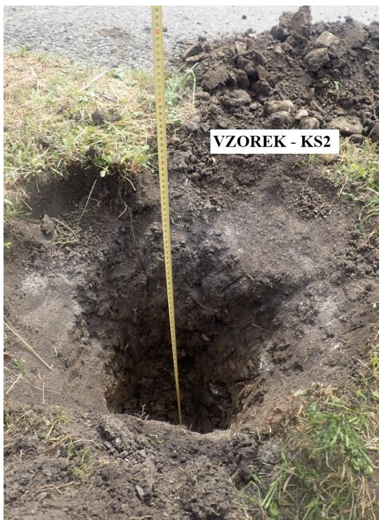
Obr. 2 – Kopaná sonda – KS2 (in situ).
