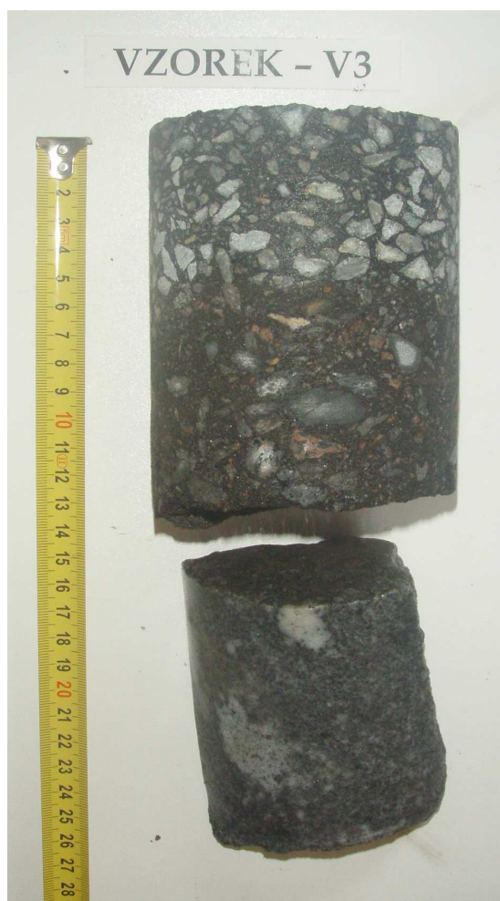
Obr. 6 - Jádro vývrtu Vzorek – V3 (laboratoř).
