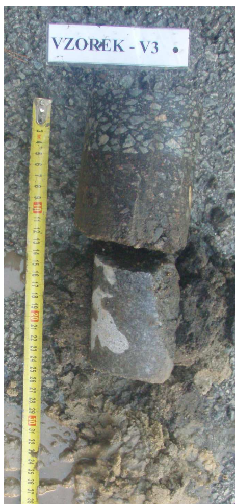
Obr. 5 - Jádro vývrtu Vzorek – V3 (in situ).
