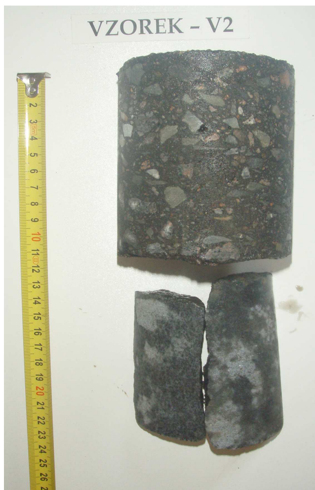
Obr. 4 - Jádru vývrtu Vzorek – V2 (laboratoř).
