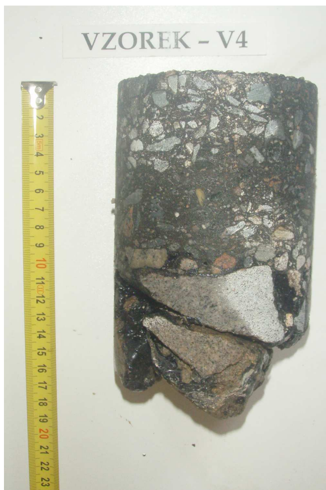
Obr. 8 - Jádru vývrtu Vzorek – V4 (laboratoř).
