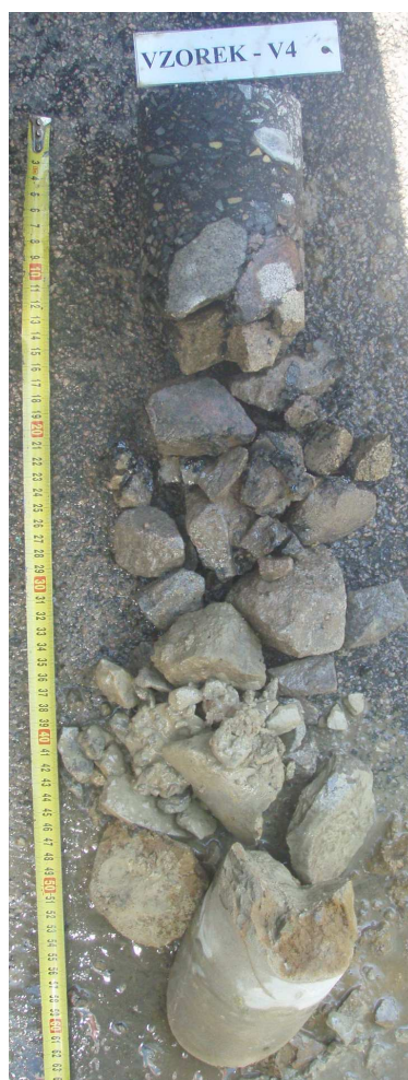
Obr. 7 - Jádro vývrtu Vzorek – V4 (in situ).
