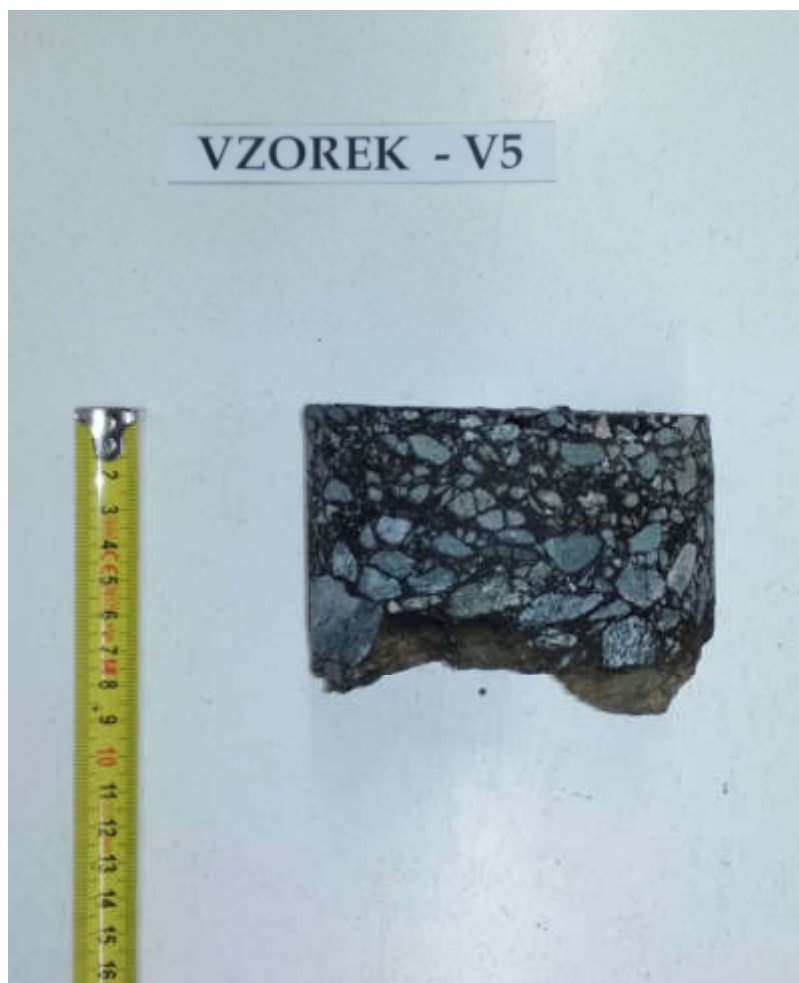
Obr. 10 - Jádro vývrtu Vzorek – V5 (laboratoř).
