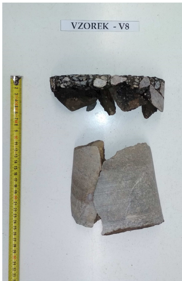
Obr. 16 - Jádro vývrtu Vzorek – V8 (laboratoř).
