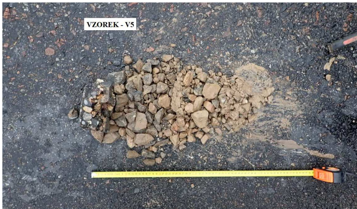
Obr. 9 - Jádro vývrtu Vzorek – V5 (in situ).
