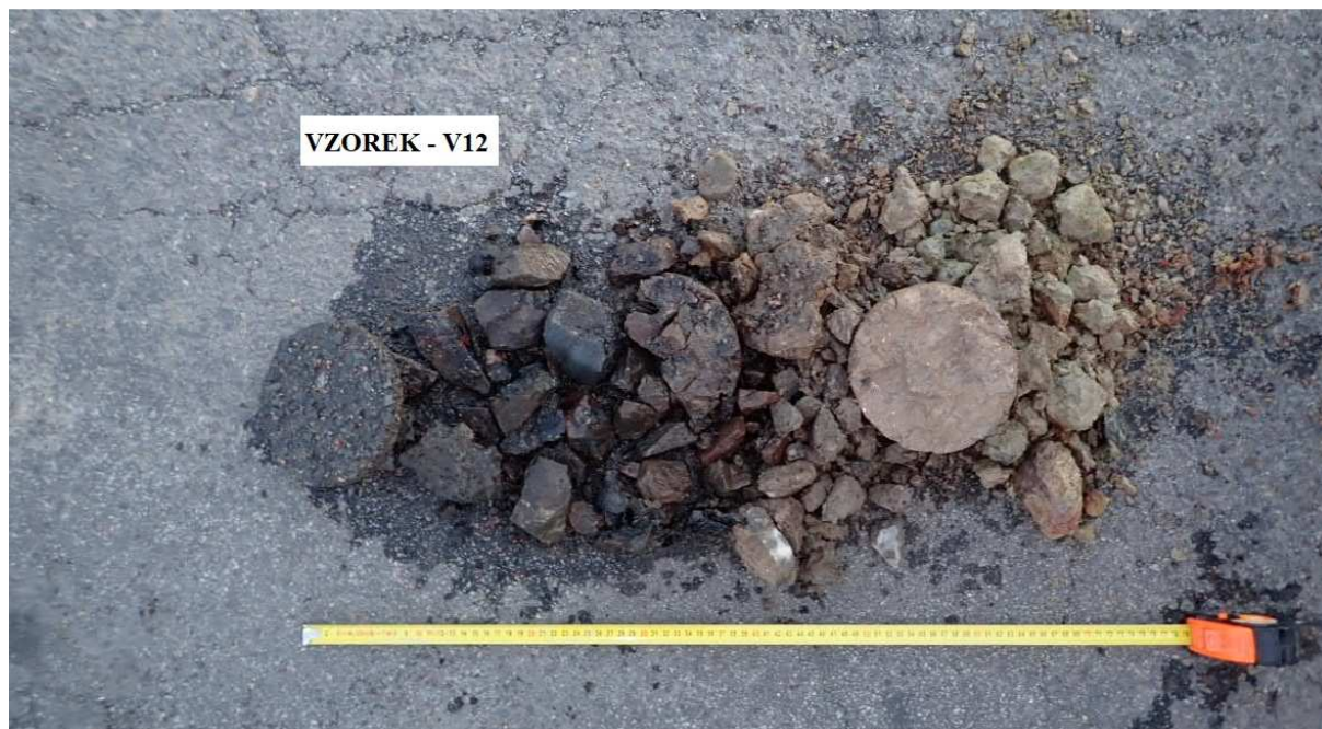
Obr. 23 - Jádro vývrtu Vzorek – V12 (in situ).
