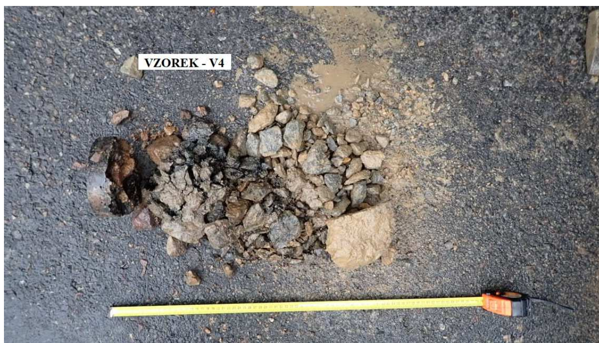
Obr. 7 - Jádro vývrtu Vzorek – V4 (in situ).
