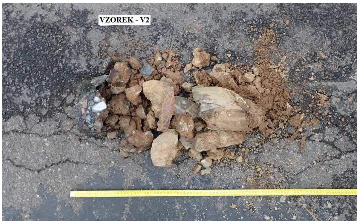
Obr. 3 - Jádro výtvetu Vzorek – V2 (in situ).
