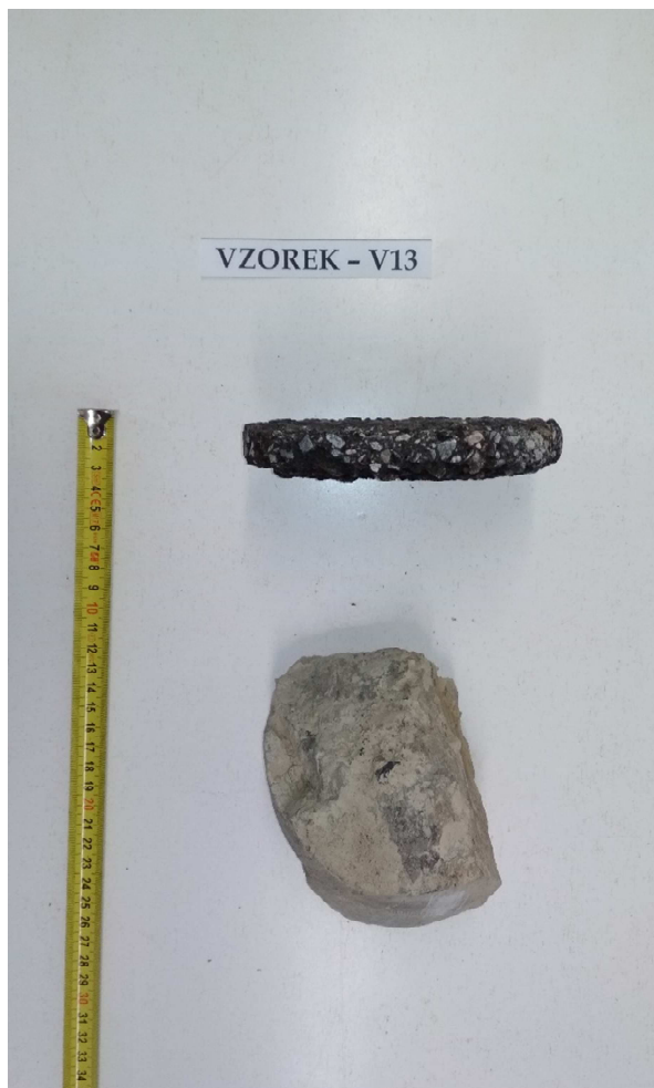
Obr. 26 - Jádru vývrtu Vzorek – V13 (laboratoř).
