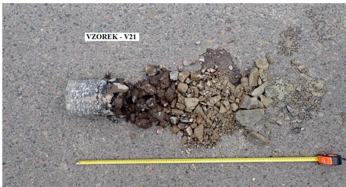
Obr. 41 - Jádro vývrtu Vzorek – V21 (in situ).
