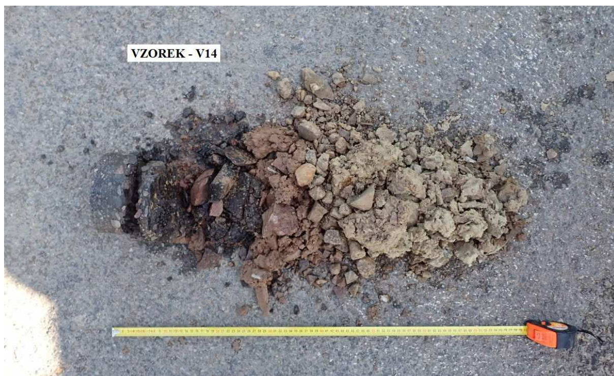
Obr. 27 - Jádro vývrtu Vzorek – V14 (in situ).
