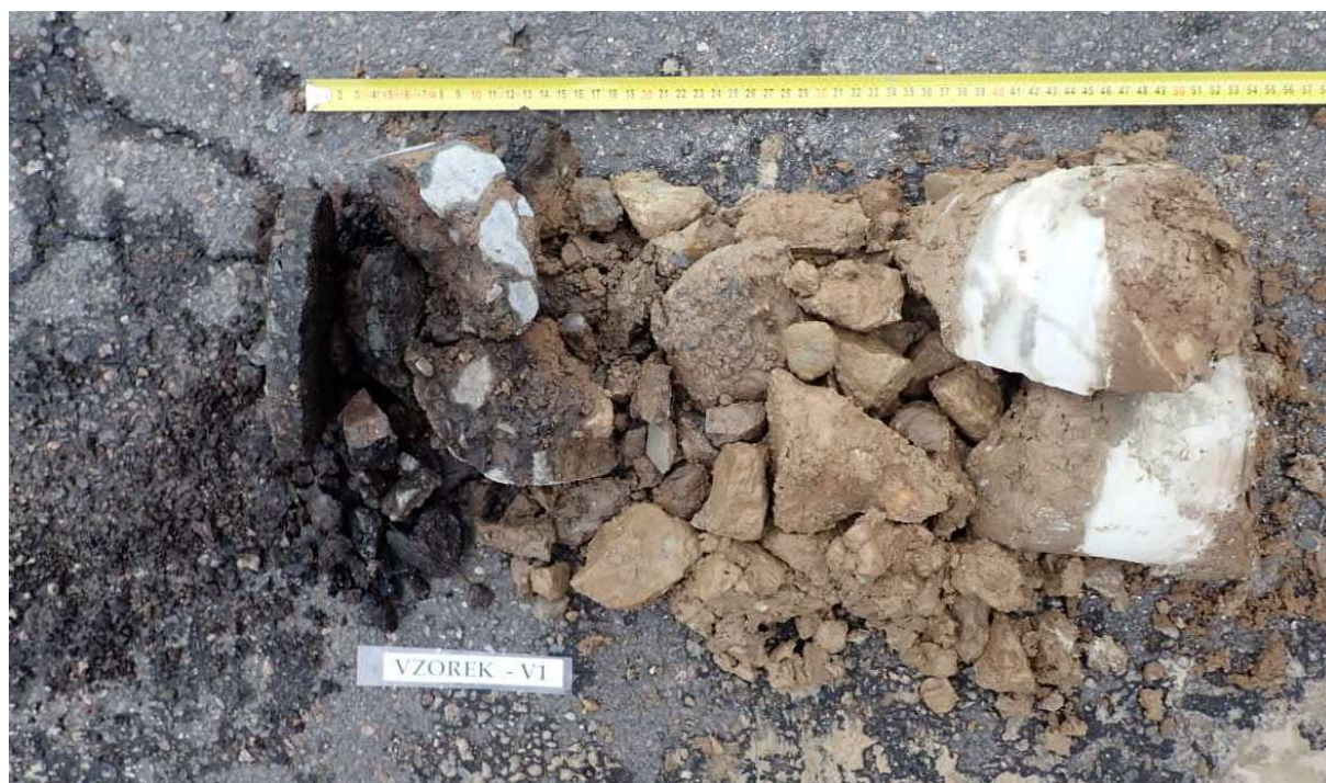
Obr. 1 - Jádro vývrtu Vzorek – V1 (in situ).
