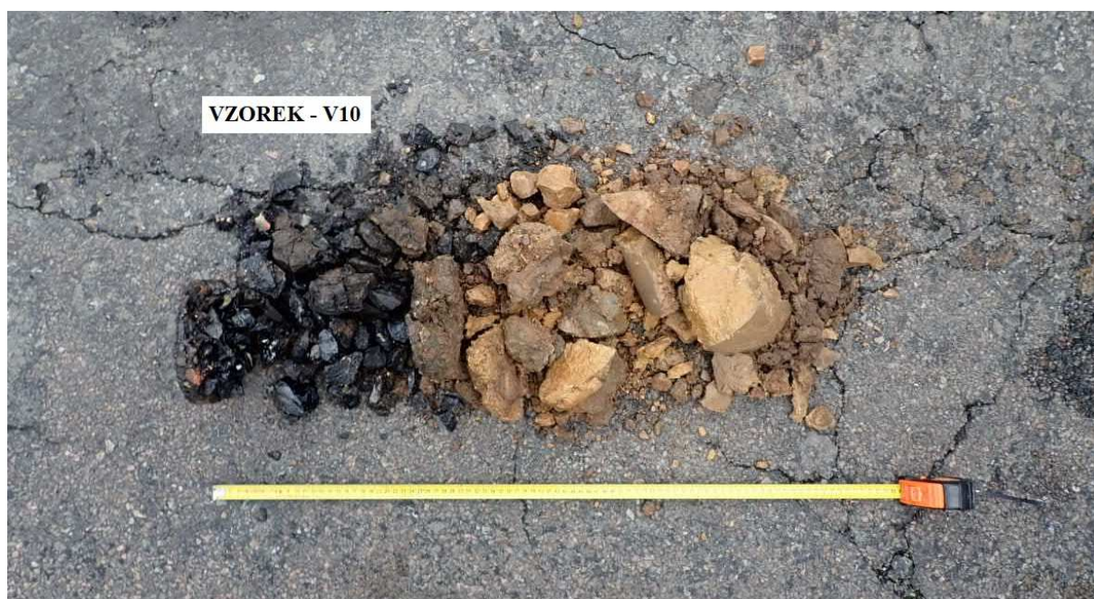
Obr. 19 - Jádro vývrtu Vzorek – V10 (in situ).
