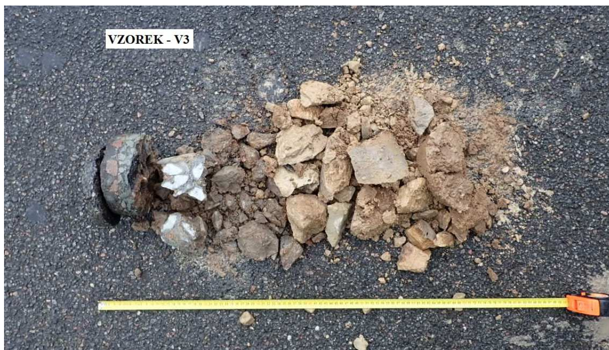
Obr. 5 - Jádro vývrtu Vzorek – V3 (in situ).
