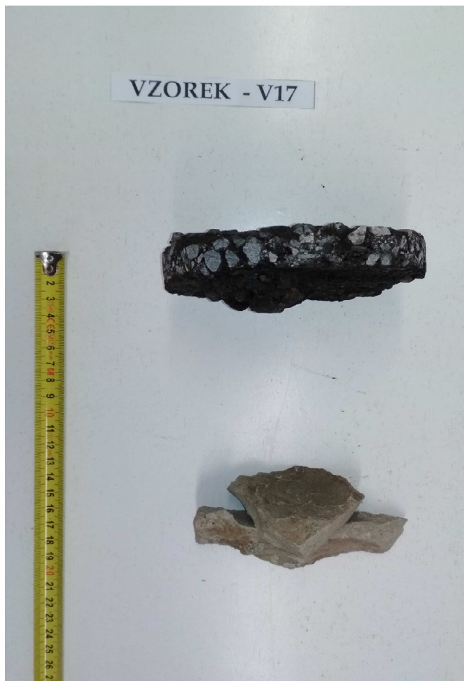
Obr. 34 - Jádru vývrtu Vzorek – V17 (laboratoř).
