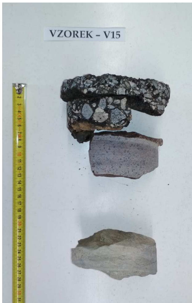
Obr. 30 - Jádru vývrtu Vzorek – V15 (laboratoř).
