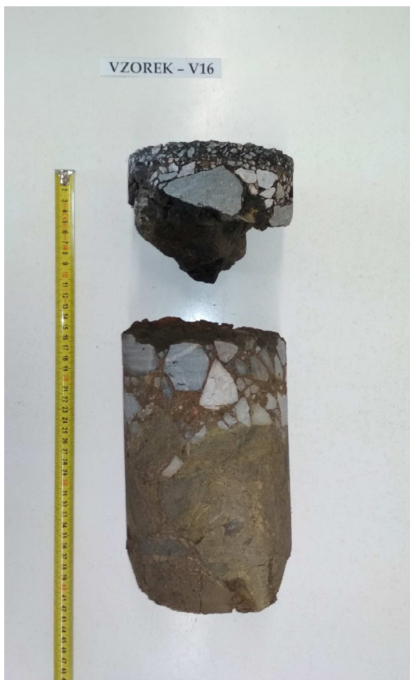
Obr. 32 - Jádro vývrtu Vzorek – V16 (laboratoř).
