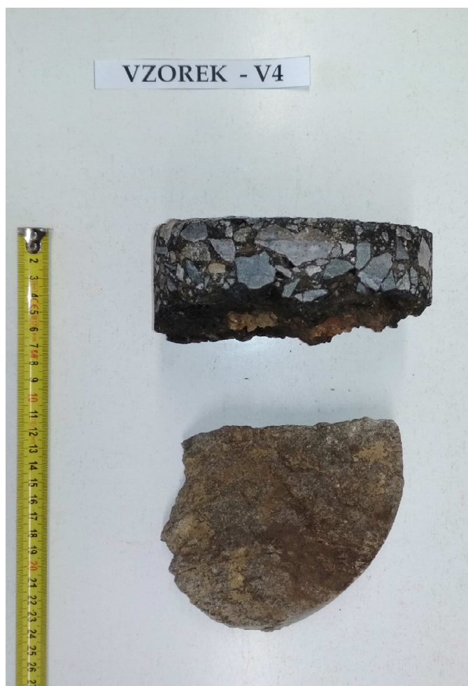
Obr. 8 - Jádro vývrtu Vzorek – V4 (laboratoř).
