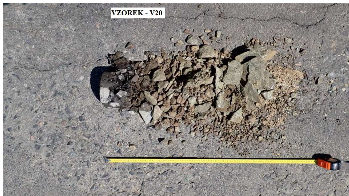
Obr. 39 - Jádro vývrtu Vzorek – V20 (in situ).
