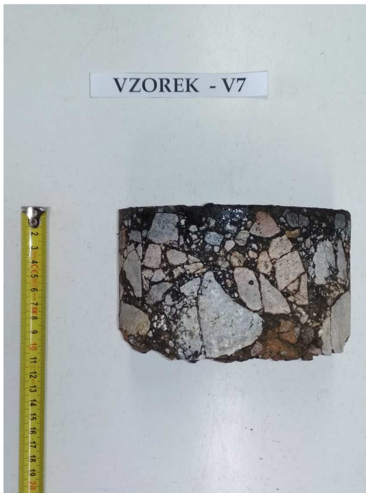
Obr. 14 - Jádru vývrtu Vzorek – V7 (laboratoř).
