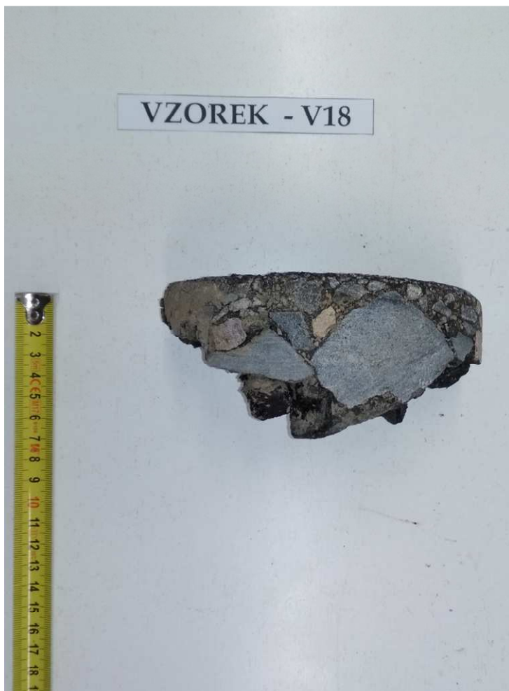
Obr. 36 - Jádro vývrtu Vzorek – V18 (laboratoř).
