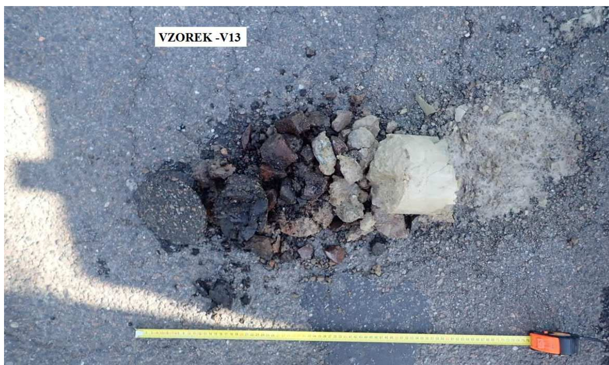
Obr. 25 - Jádro vývrtu Vzorek – V13 (in situ).
