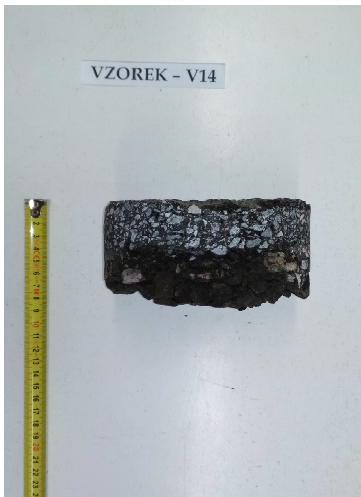
Obr. 28 - Jádru vývrtu Vzorek – V14 (laboratoř).
