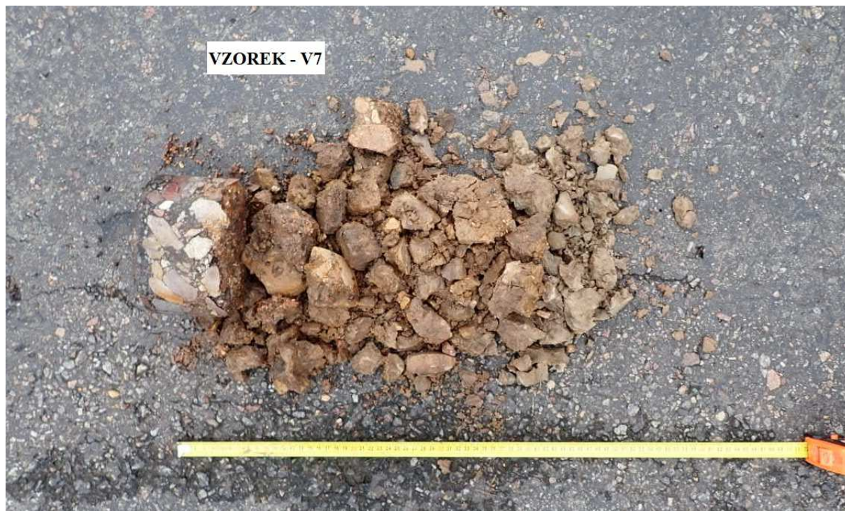
Obr. 13 - Jádro vývrtu Vzorek – V7 (in situ).
