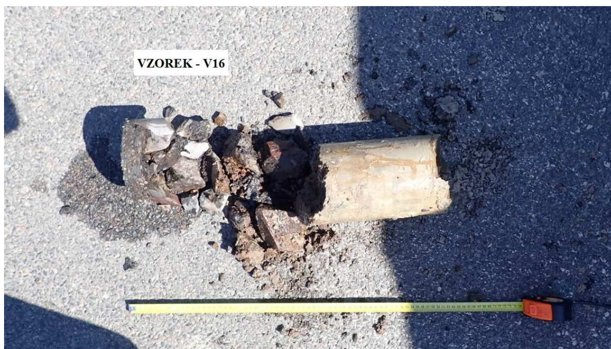
Obr. 31 - Jádro vývrtu Vzorek – V16 (in situ).
