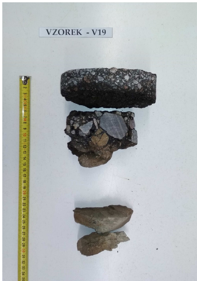
Obr. 38 - Jádru vývrtu Vzorek – V19 (laboratoř).
