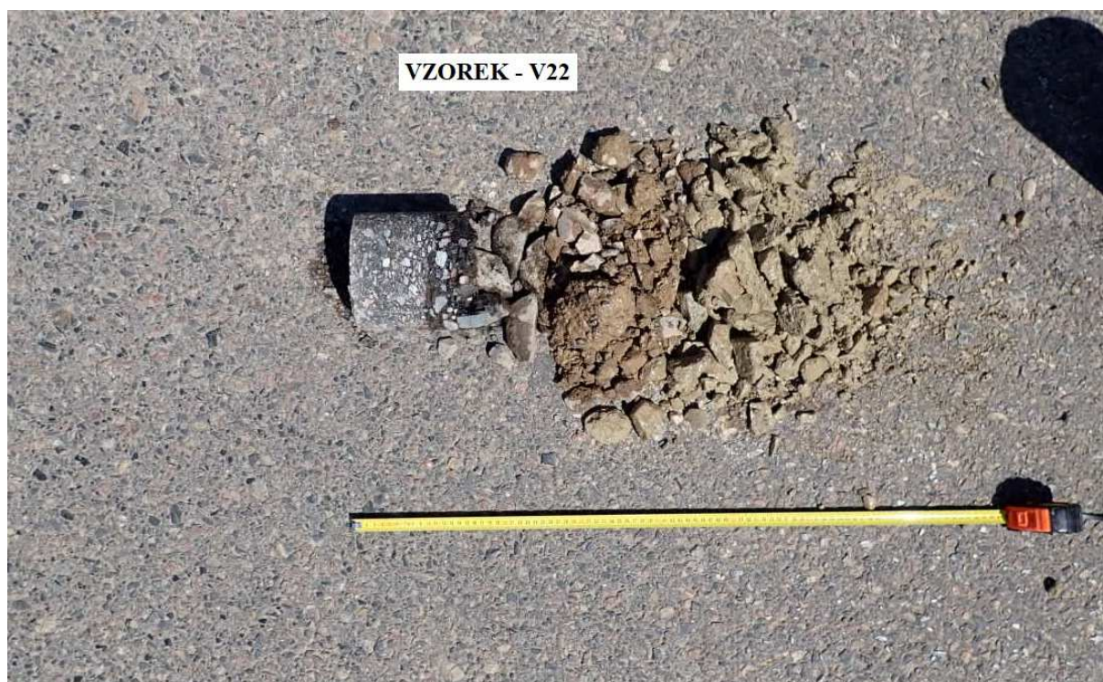
Obr. 43 - Jádro vývrtu Vzorek – V22 (in situ).
