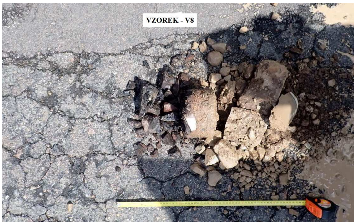
Obr. 15 - Jádro vývrtu Vzorek – V8 (in situ).
