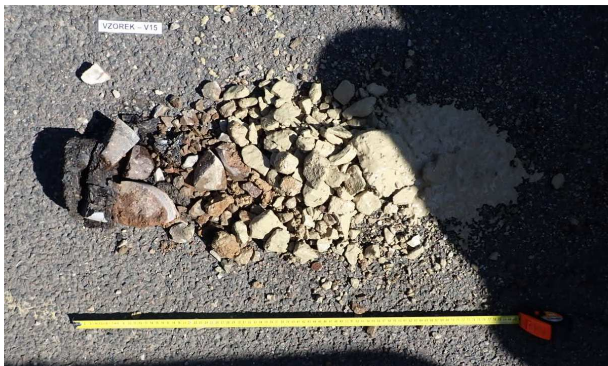
Obr. 29 - Jádro vývrtu Vzorek – V15 (in situ).
