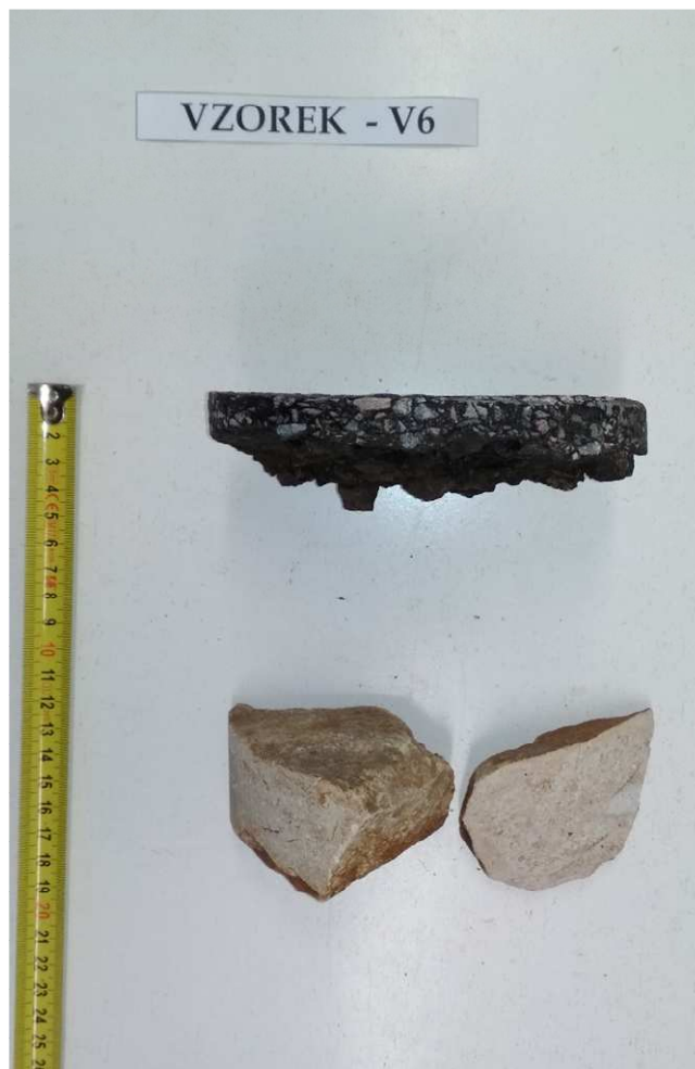
Obr. 12 - Jádro vývrtu Vzorek – V6 (laboratoř).
