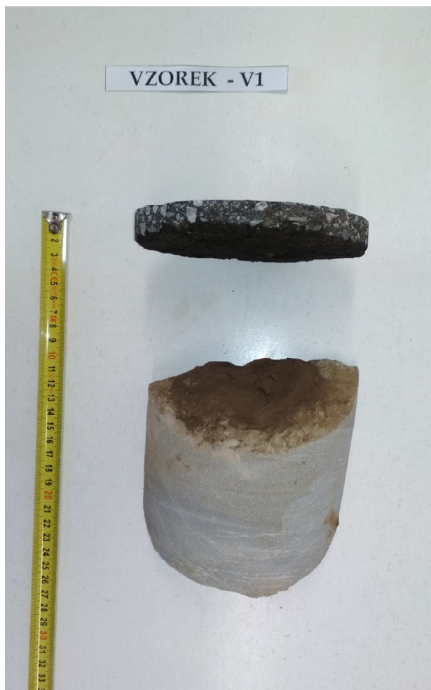
Obr. 2 - Jádru vývrtu Vzorek – V1 (laboratoř).
