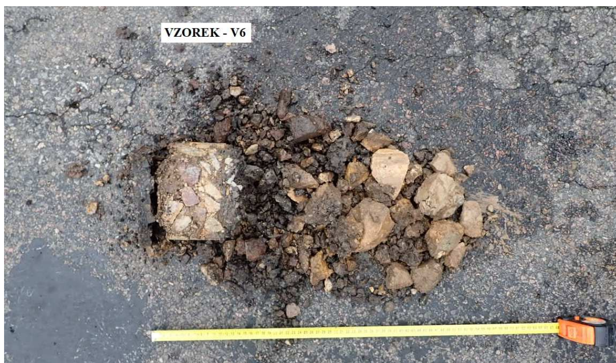
Obr. 11- Jádro vývrtu Vzorek – V6 (in situ).
