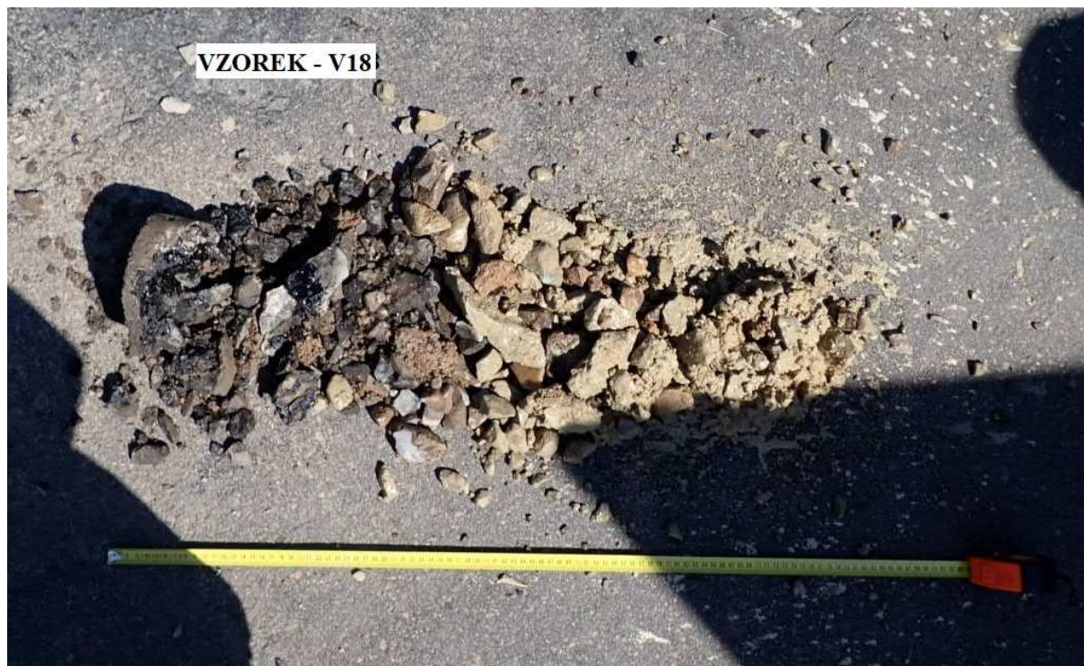
Obr. 35 - Jádro vývrtu Vzorek – V18 (in situ).
