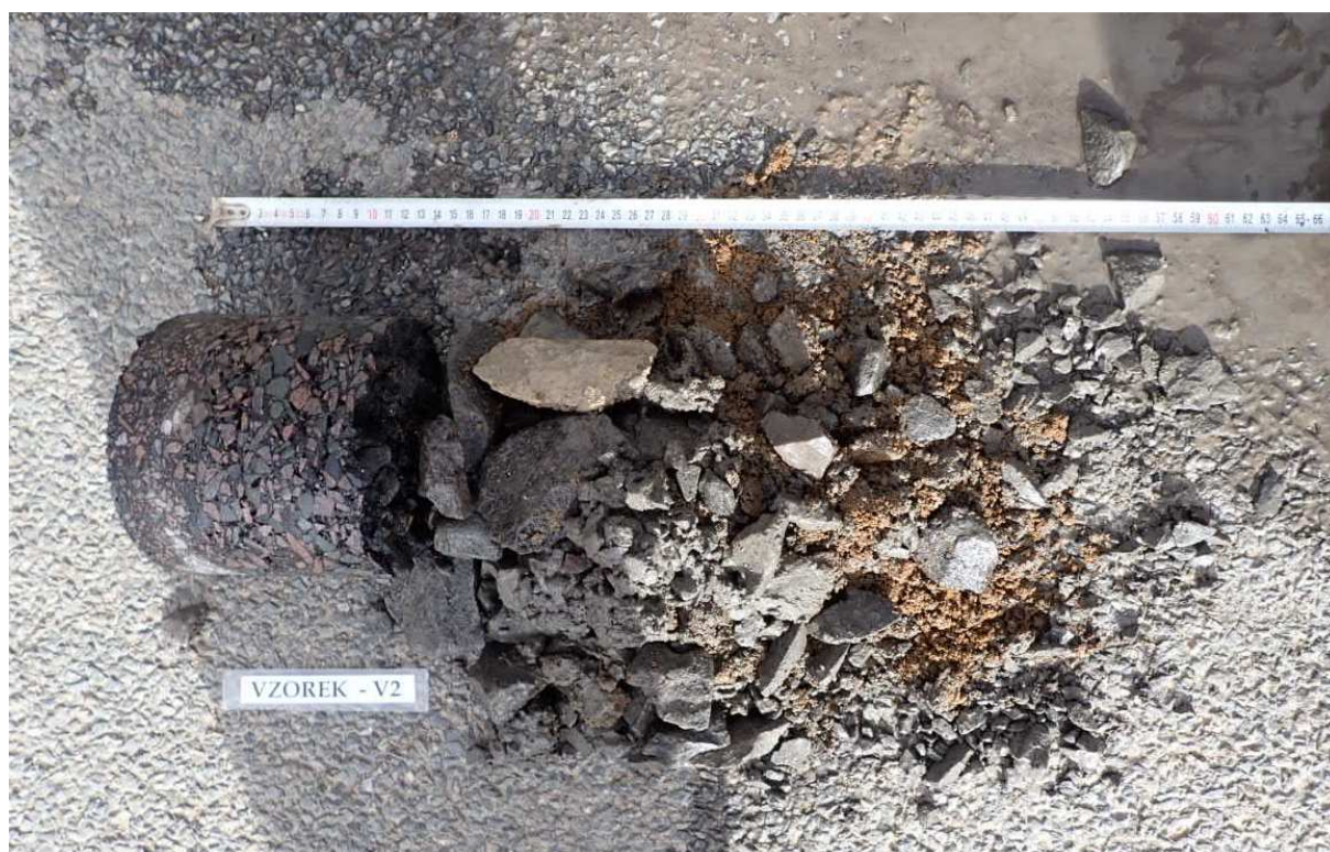
Obr. 3 - Jádru vývrtu Vzorek – V2 (in situ).
