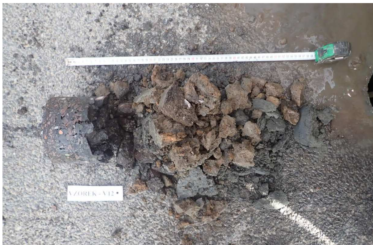
Obr. 23 - Jádro vývrtu Vzorek – V12 (in situ).
