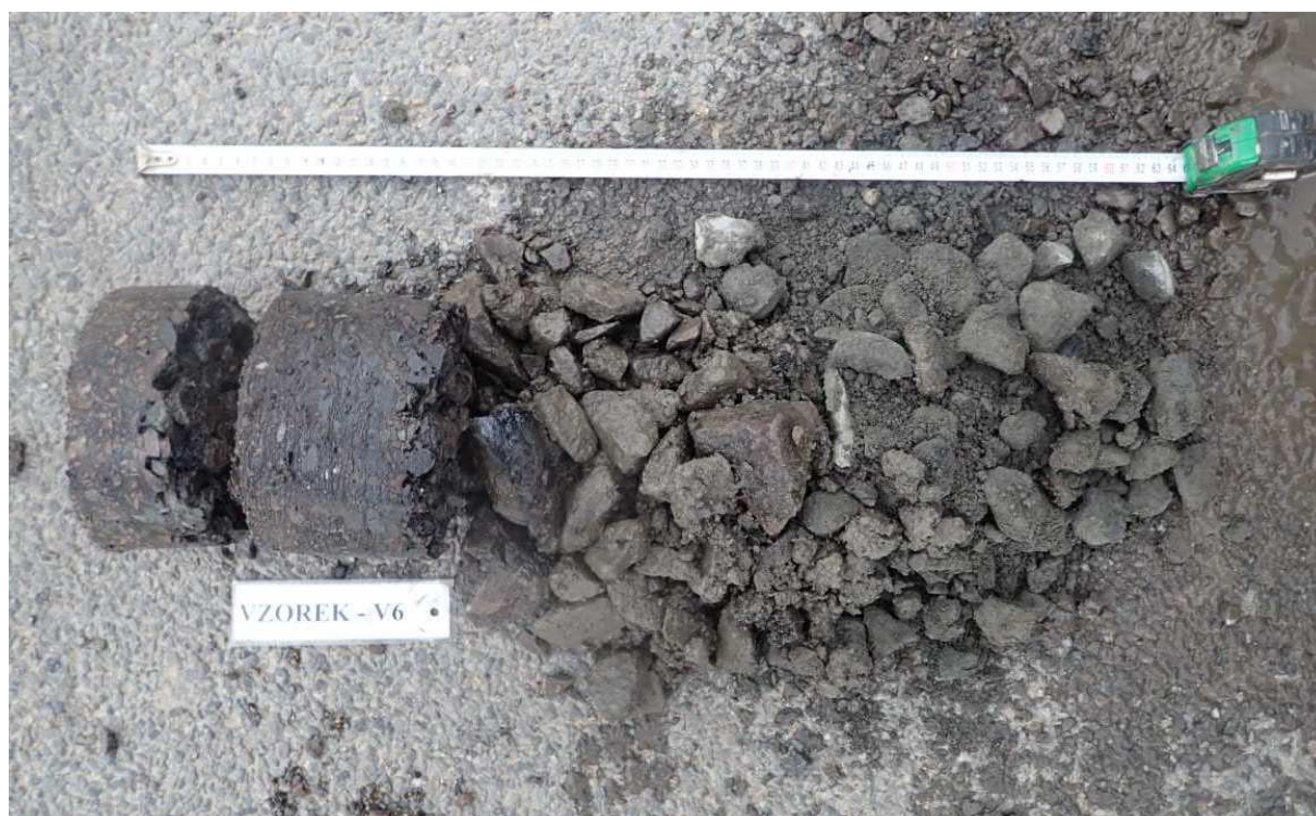
Obr. 11 - Jádno vřvtu Vzorek – V6 (in situ).
