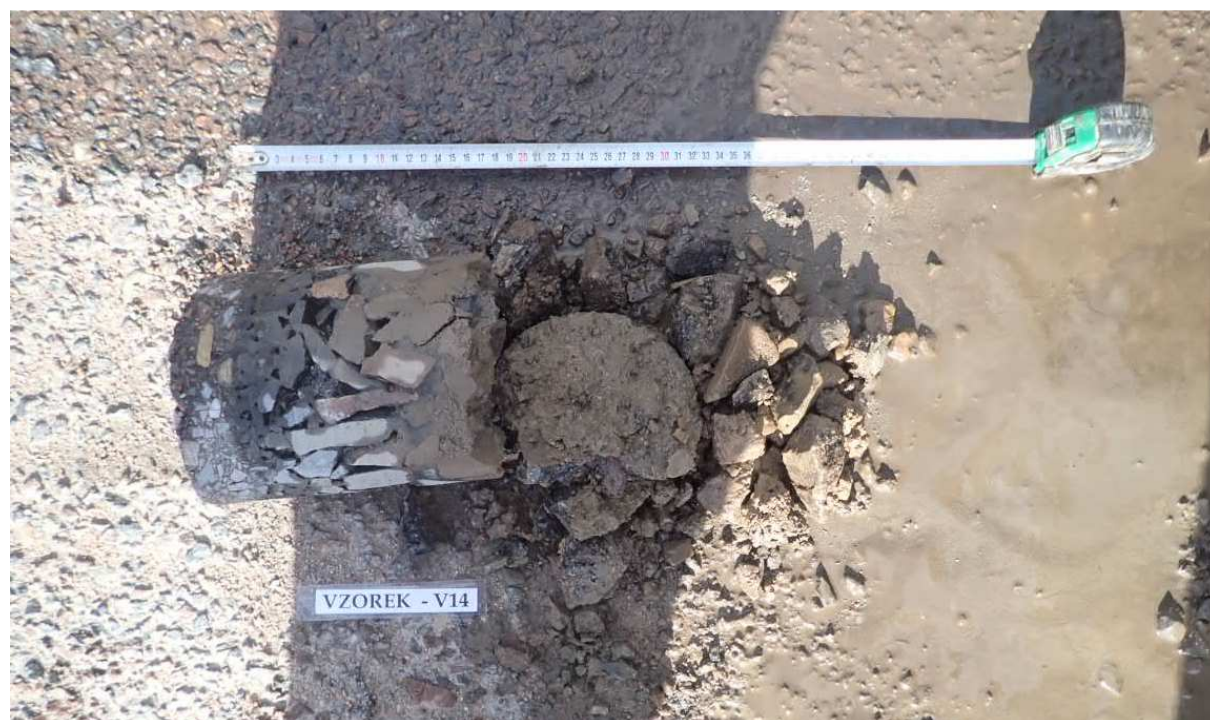
Obr. 27 - Jádro vývrtu Vzorek – V14 (in situ).
