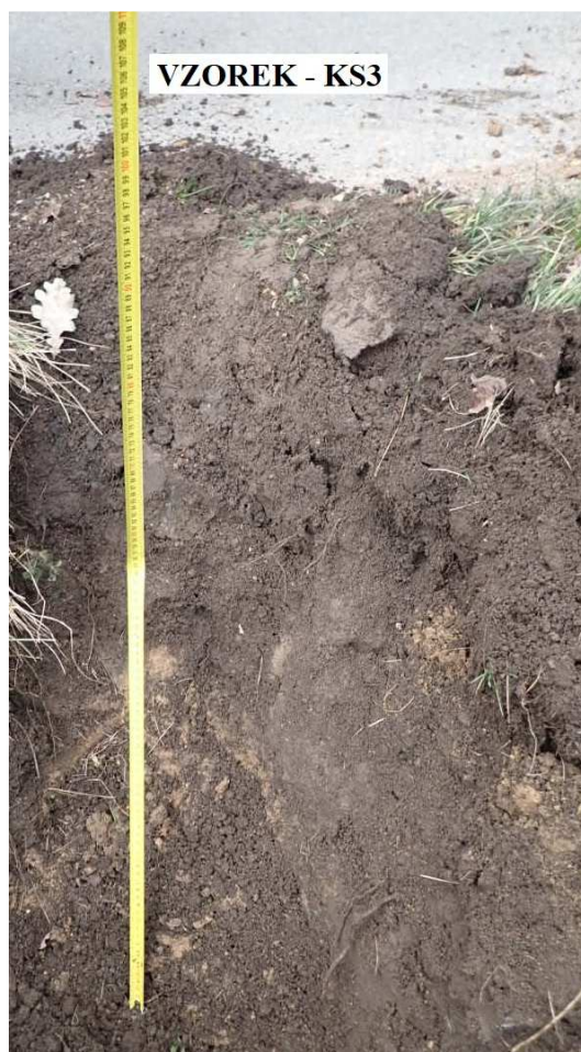
Obr. 31 - Jádru vývrtu Vzorek – KS3 (in situ).
