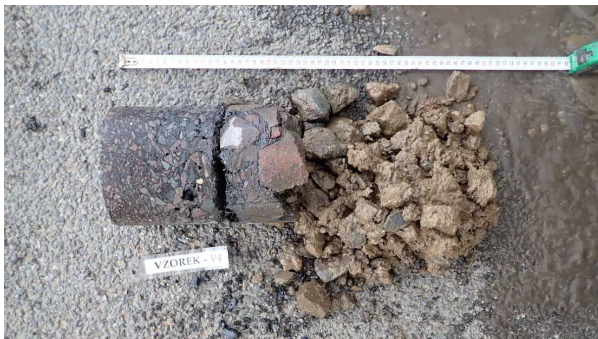
Obr. 7 - Jádro vývrtu Vzorek – V4 (in situ).
