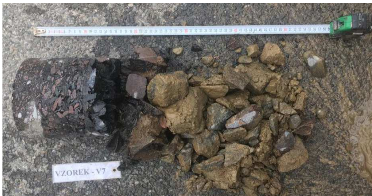
Obr. 13 - Jádro vývrtu Vzorek – V7 (in situ).
