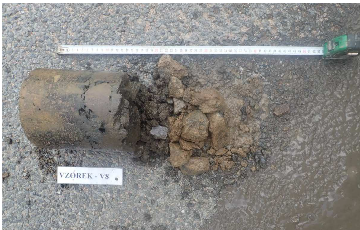
Obr. 15 - Jádro vývrtu Vzorek – V8 (in situ).
