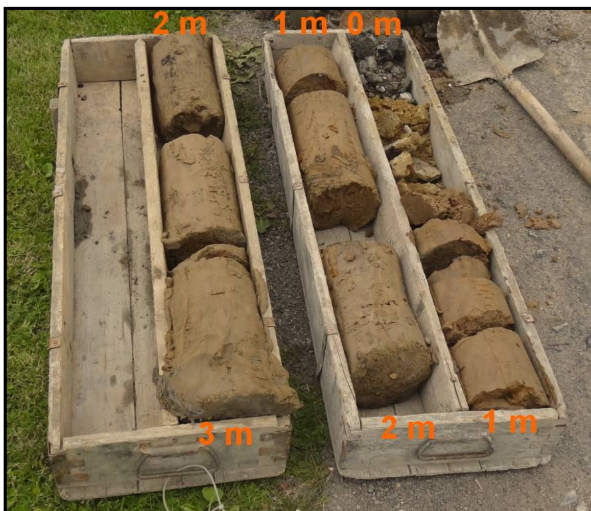
Obr. č. 6: Geologický profil sondy HT-3
