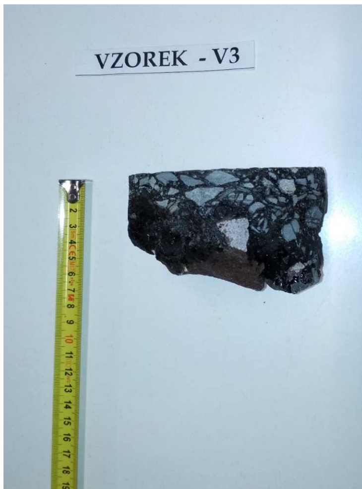
Obr. 6 - Jádru vývrtu Vzorek – V3 (laboratoř).
