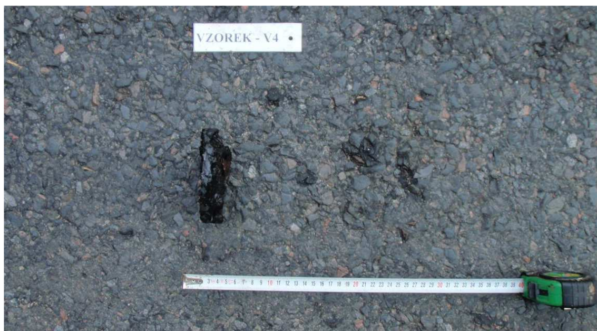
Obr. 7 - Jádro vývrtu Vzorek – V4 (in situ).
