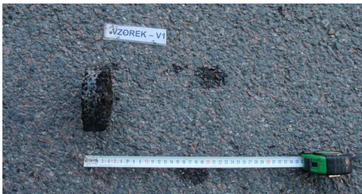
Obr. 1 - Jádru vývrtu Vzorek – V1 (in situ).
