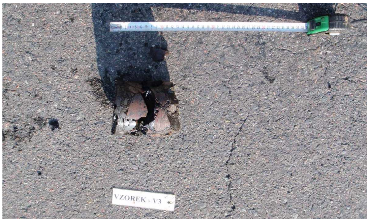
Obr. 5 - Jádro vývrtu Vzorek – V3 (in situ).
