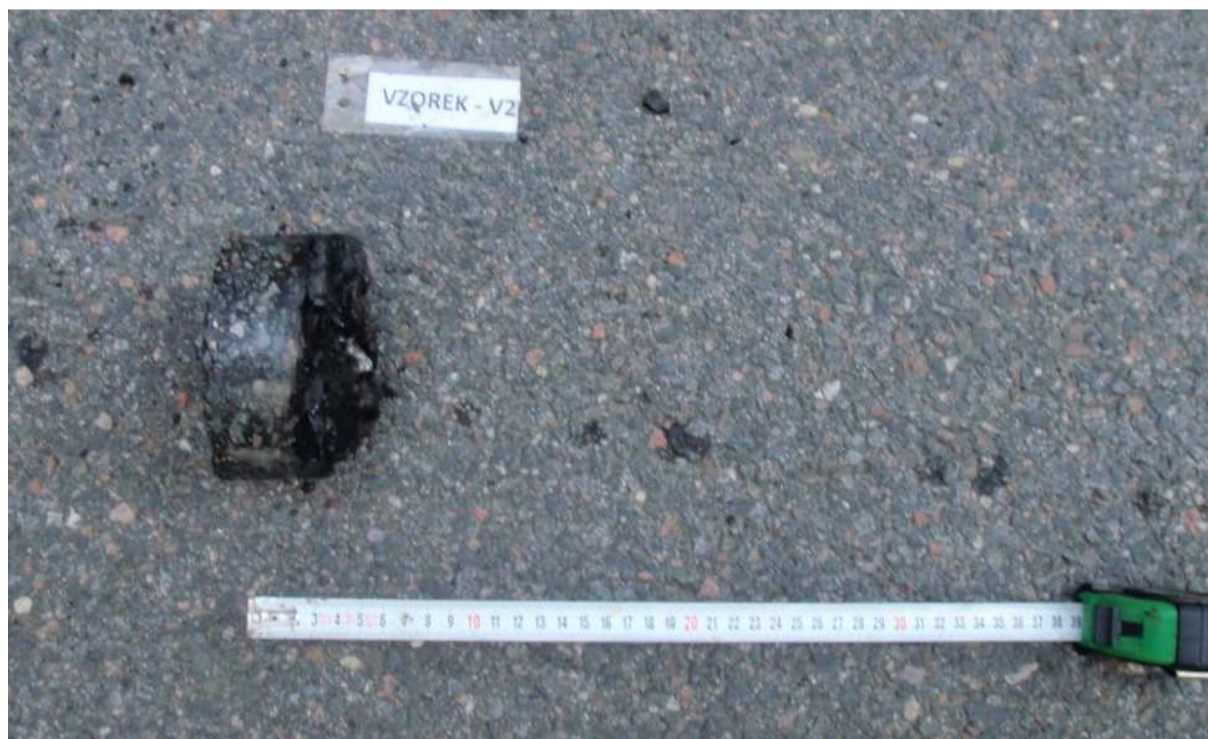
Obr. 3 - Jádro vývrtu Vzorek – V2 (in situ).
