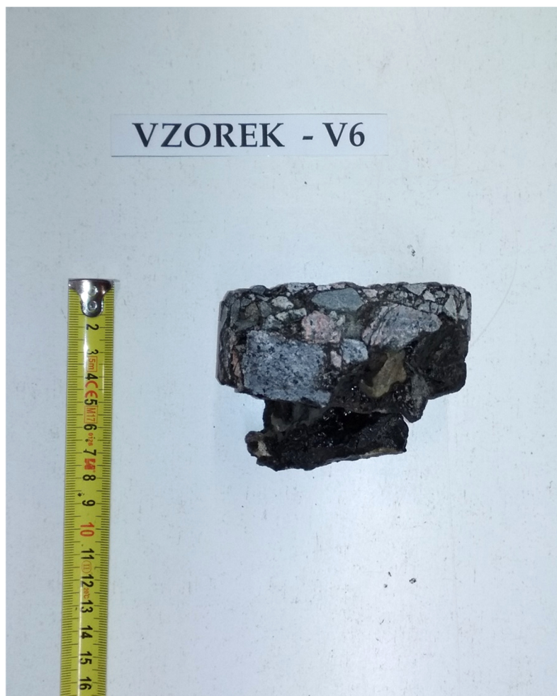
Obr. 7 - Jádru vývrtu Vzorek – V6 (laboratoř).
