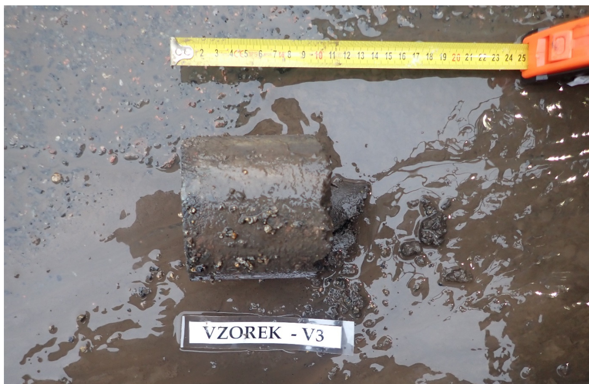
Obr. 1 - Jádro vývrtu Vzorek – V3 (in situ).
