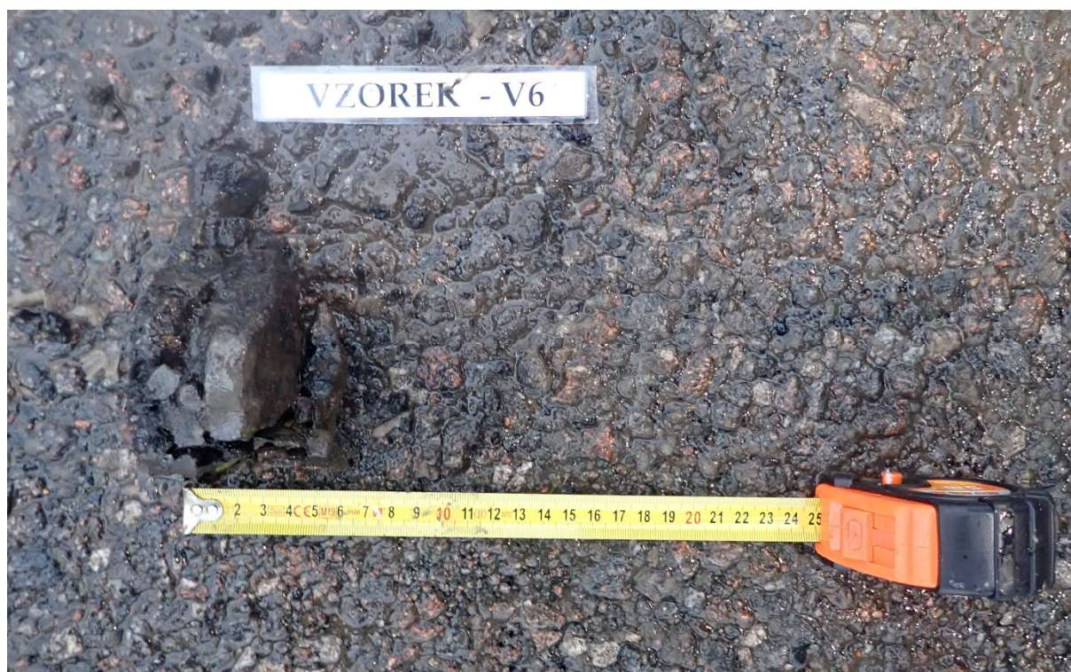
Obr. 6 - Jádro vývrtu Vzorek – V6 (in situ).
