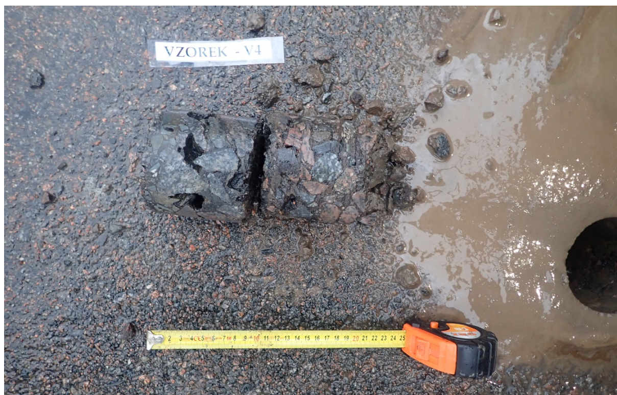
Obr. 3 - Jádro výtvtu Vzorek – V4 (in situ).
