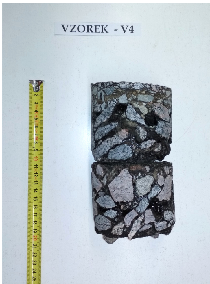
Obr. 4 - Jádro vývrtu Vzorek – V4 (laboratoř).
