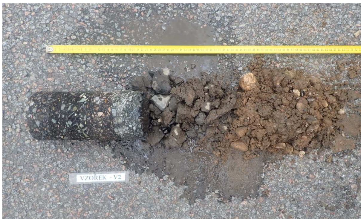
Obr. 3 - Jádro vývrtu Vzorek – V2 (in situ).
