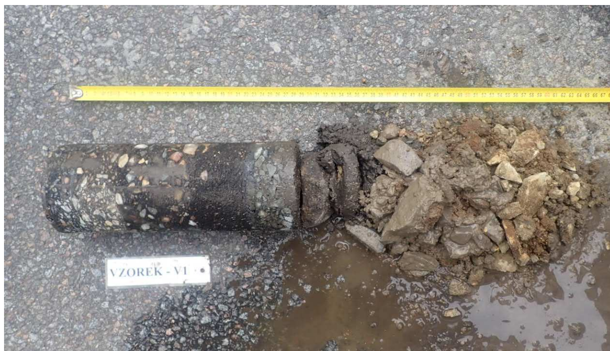
Obr. 1 - Jádru výtvetu Vzorek – V1 (in situ).
