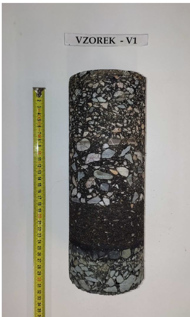
Obr. 2 - Jádru vývrtu Vzorek – V1 (laboratoř).
