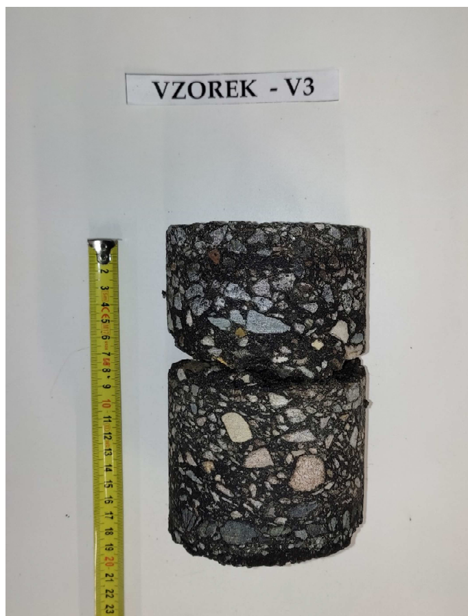
Obr. 6 - Jádru vývrtu Vzorek – V3 (laboratoř).
