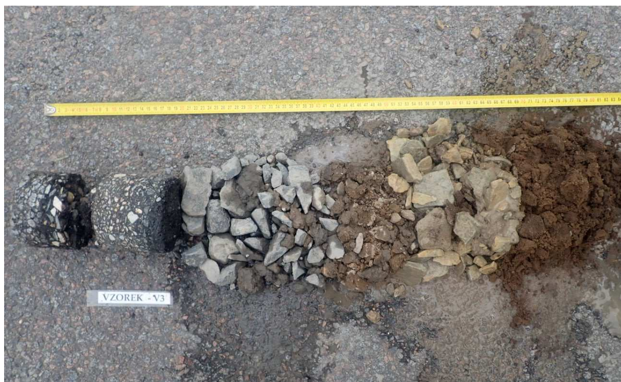
Obr. 5 - Jádro vývrtu Vzorek – V3 (in situ).
