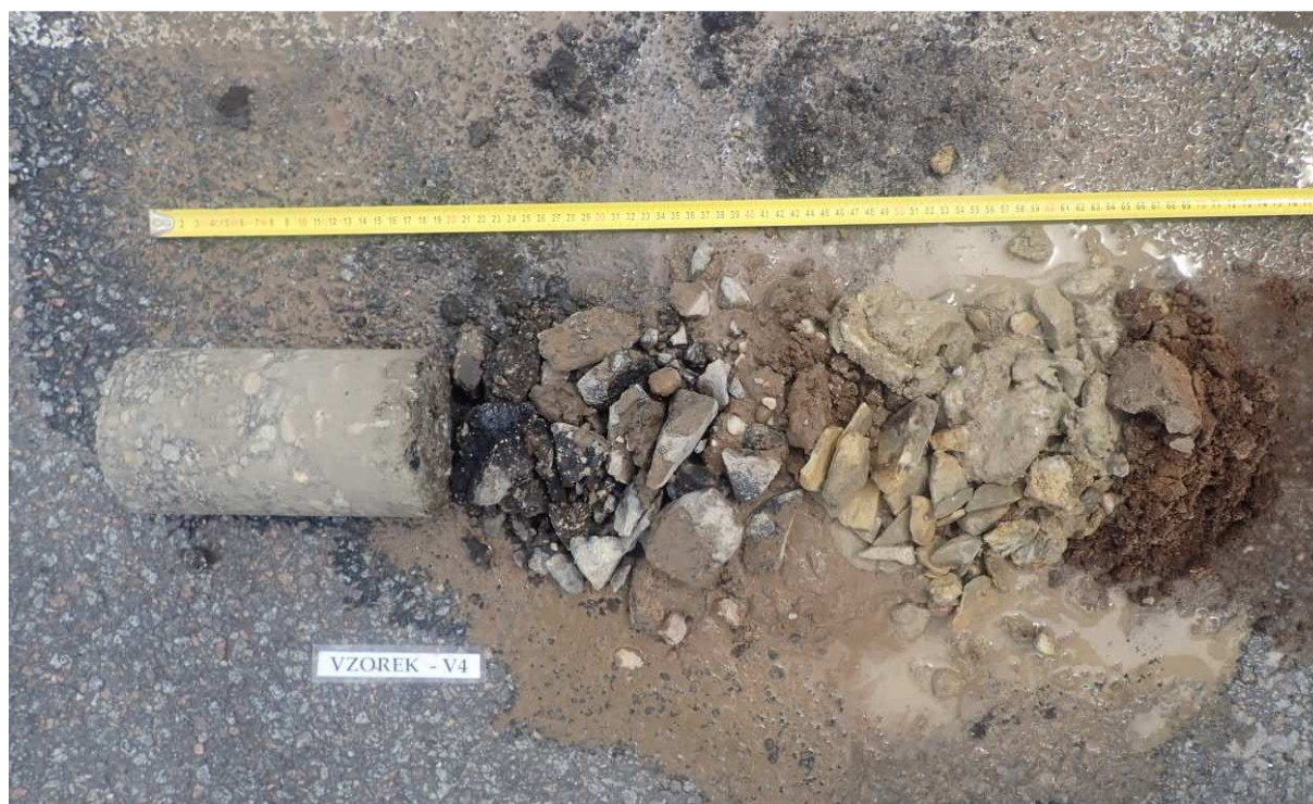
Obr. 7 - Jádro vývrtu Vzorek – V4 (in situ).
