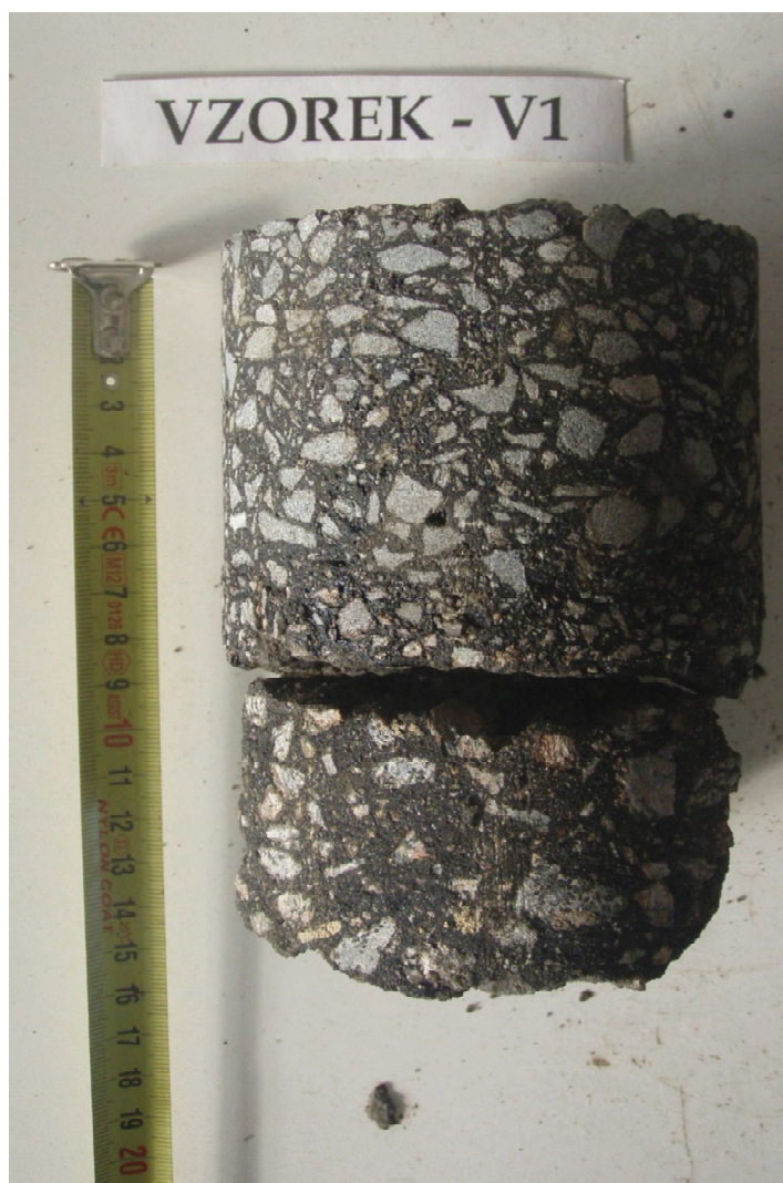
Obr. 2 - Jádru vývrtu Vzorek – V1 (laboratoř).
