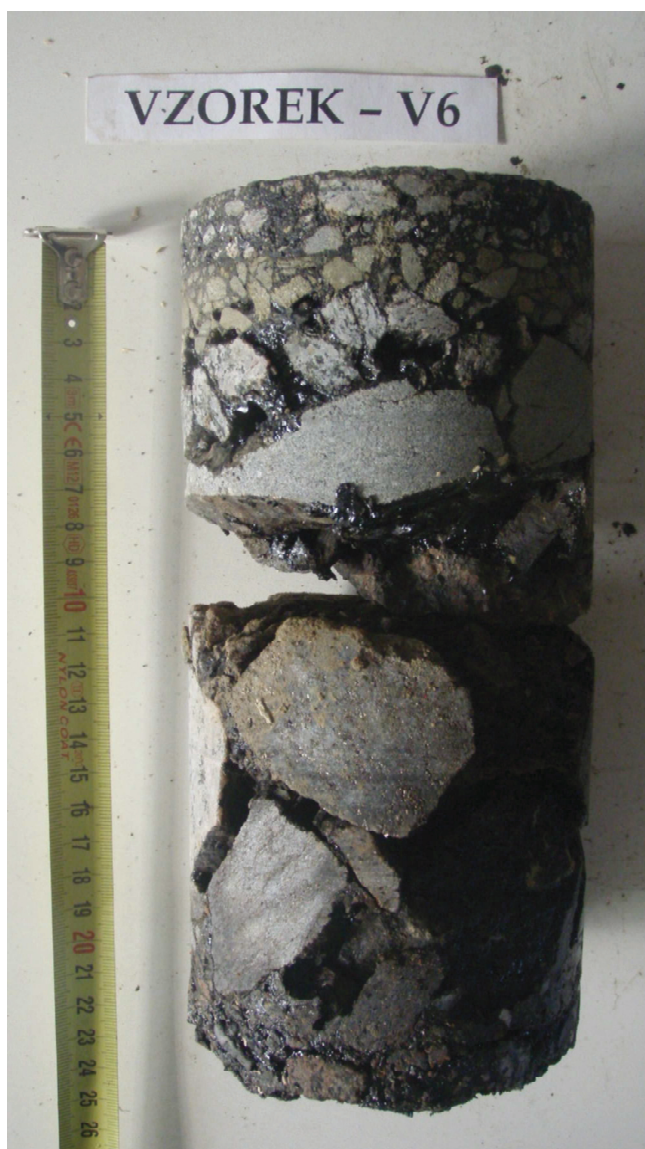
Obr. 12 - Jádro vývrtu Vzorek – V6 (laboratoř).
