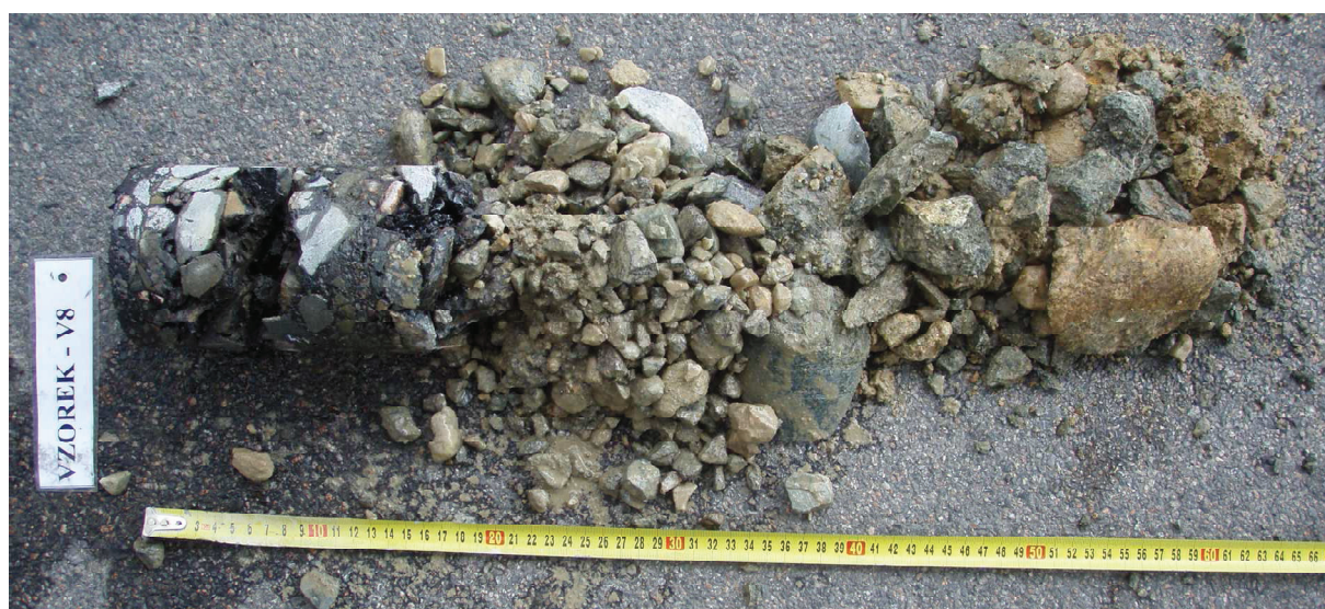
Obr. 15 - Jádru výtvtu Vzorek – V8 (in situ).
