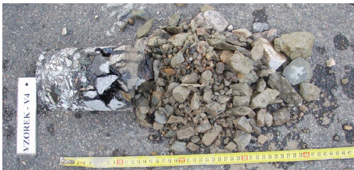
Obr. 7 - Jádro vývrtu Vzorek – V4 (in situ).
