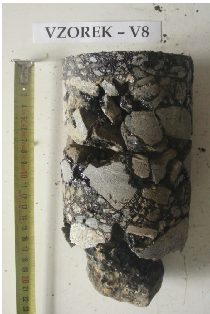
Obr. 16 - Jádro vývrtu Vzorek – V8 (laboratoř).
