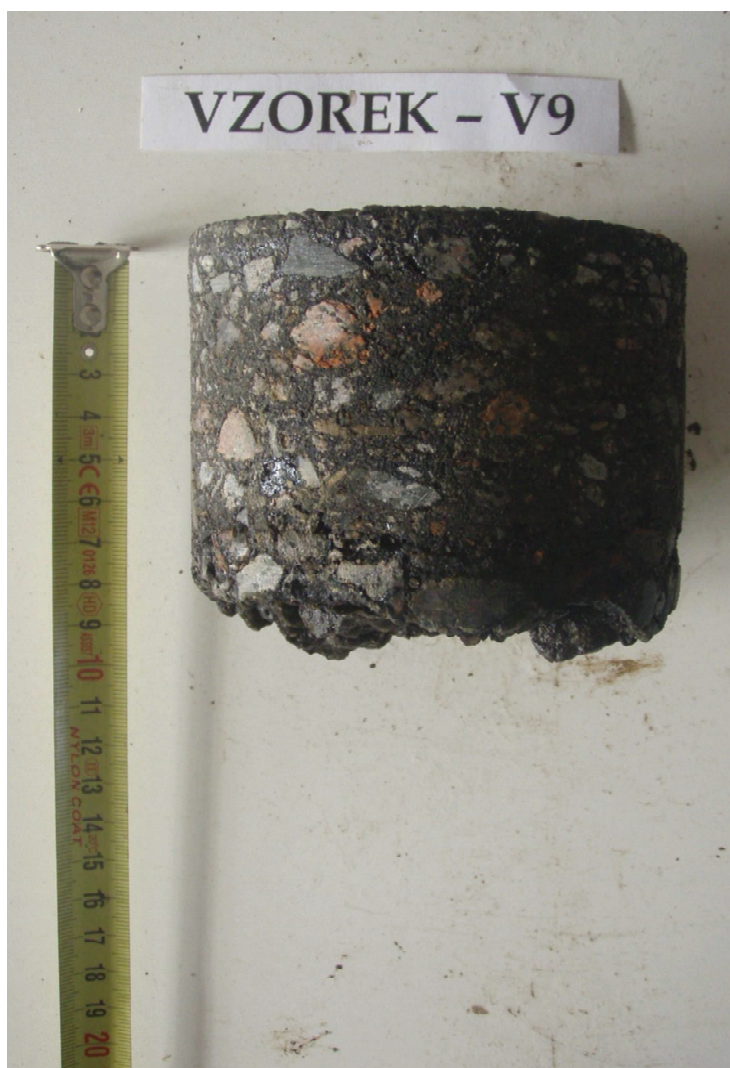
Obr. 18 - Jádro vývrtu Vzorek – V9 (laboratoř).
