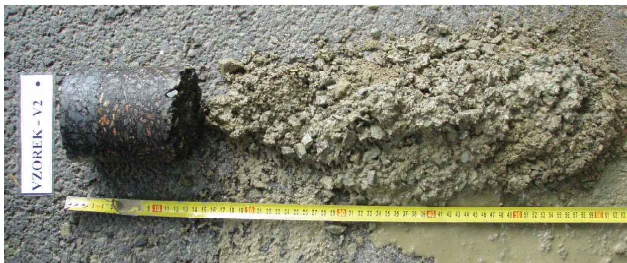
Obr. 3 - Jádro vývrtu Vzorek – V2 (in situ).
