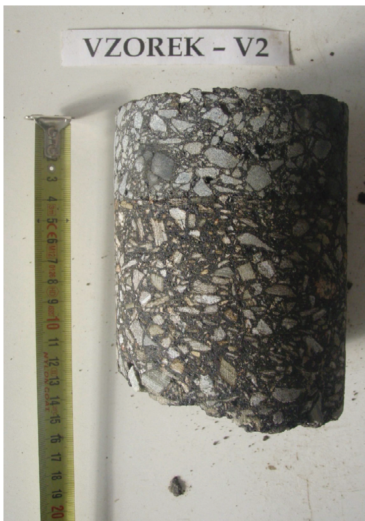
Obr. 4 - Jádro vývrtu Vzorek – V2 (laboratoř).
