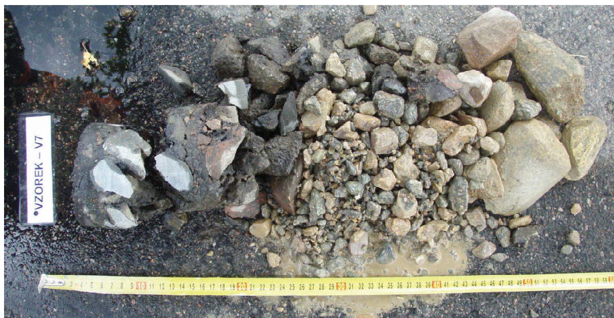
Obr. 13 - Jádro vývrtu Vzorek – V7 (in situ).
