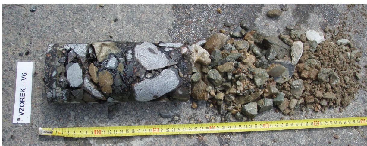
Obr. 11 - Jádru vývrtu Vzorek – V6 (in situ).
