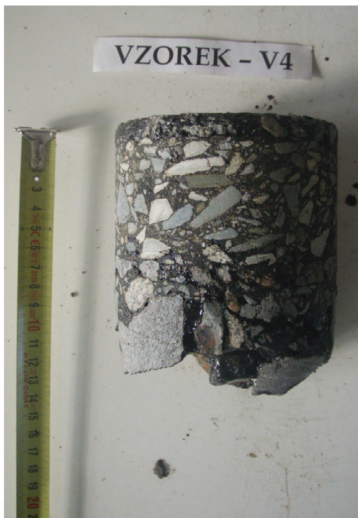
Obr. 8 - Jádru vývrtu Vzorek – V4 (laboratoř).
