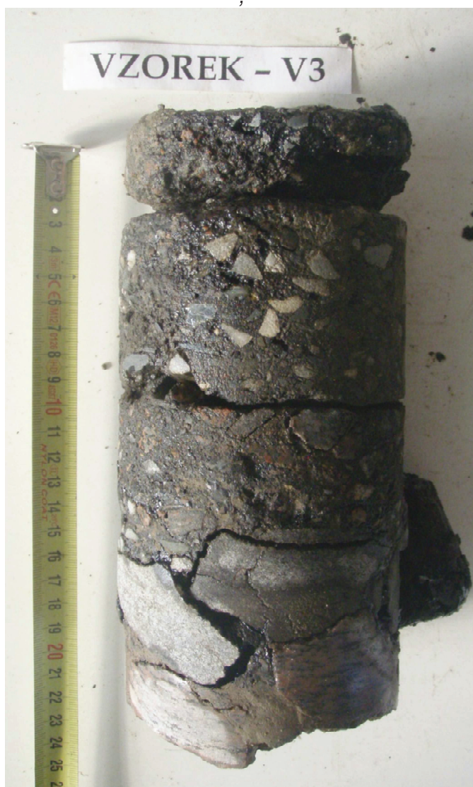
Obr. 6 - Jádru vývrtu Vzorek – V3 (laboratoř).
