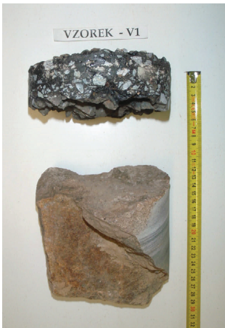
Obr. 2 - Jádro vývrtu Vzorek – V1 (laboratoř).
