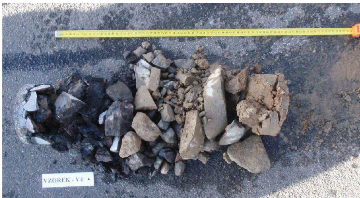
Obr. 7 - Jádro vývrtu Vzorek – V4 (in situ).
