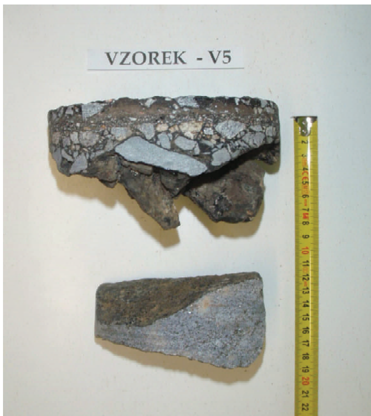
Obr. 10 - Jádro vývrtu Vzorek – V5 (laboratoř).
