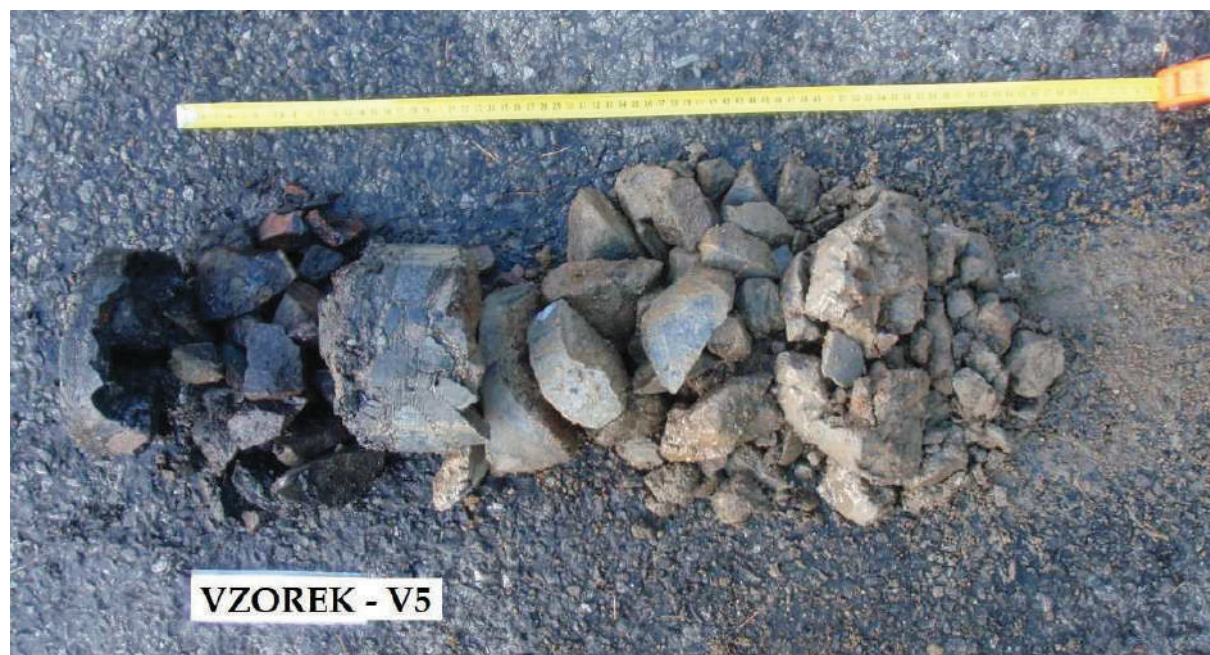
Obr. 9 - Jádro vývrtu Vzorek – V5 (in situ).
