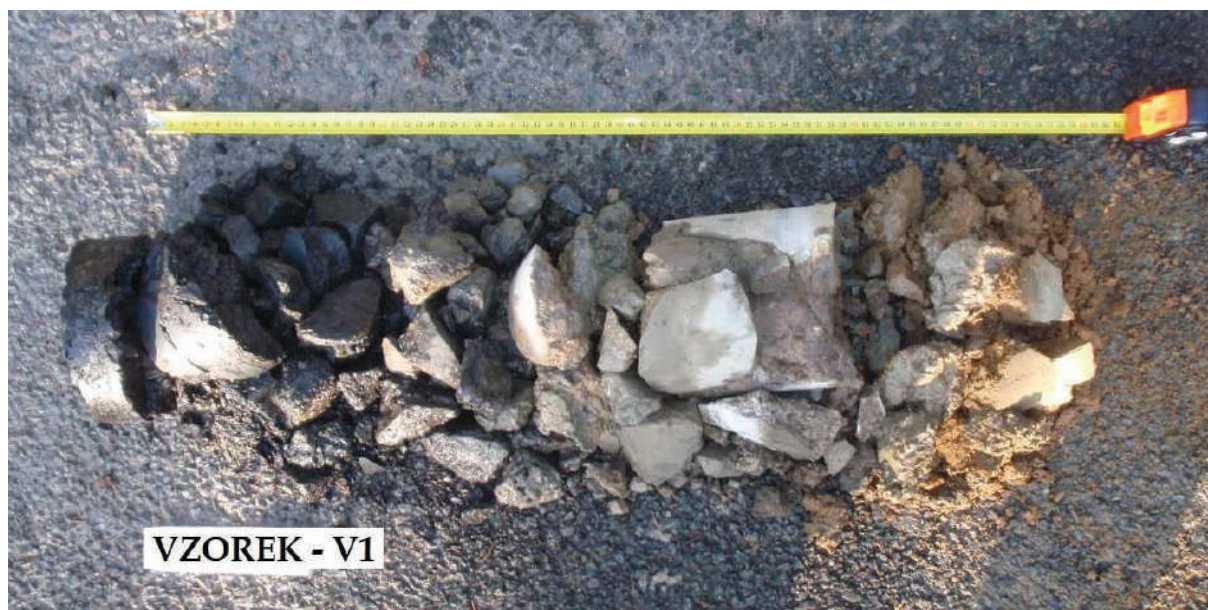
Obr. 1 - Jádro vývrtu Vzorek – V1 (in situ).
