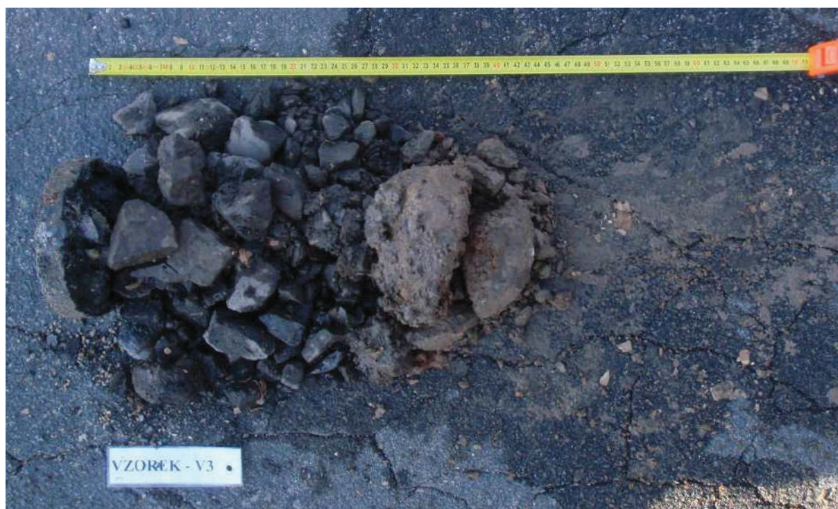
Obr. 5 - Jádro vývrtu Vzorek – V3 (in situ).
