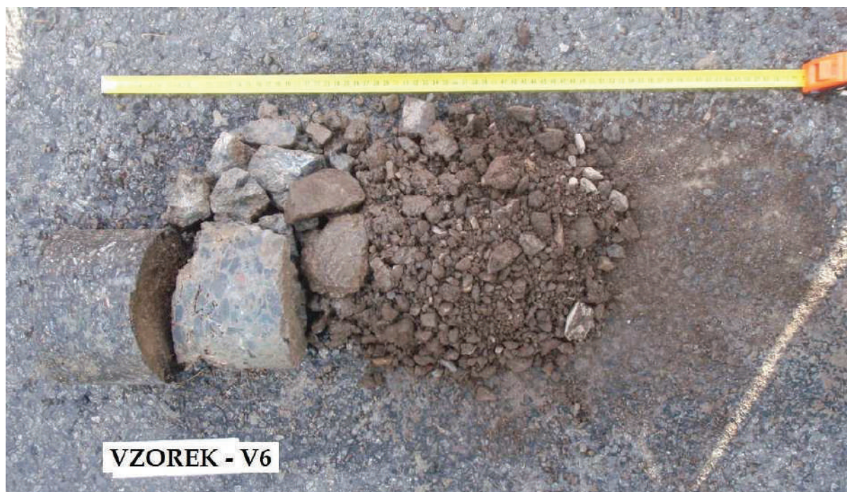
Obr. 11 - Jádro vývrtu Vzorek – V6 (in situ).
