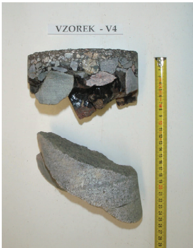
Obr. 8 - Jádro vývrtu Vzorek – V4 (laboratoř).
