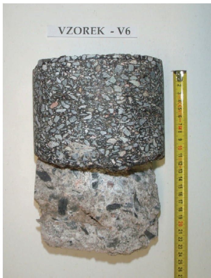
Obr. 12 - Jádro vývrtu Vzorek – V6 (laboratoř).
