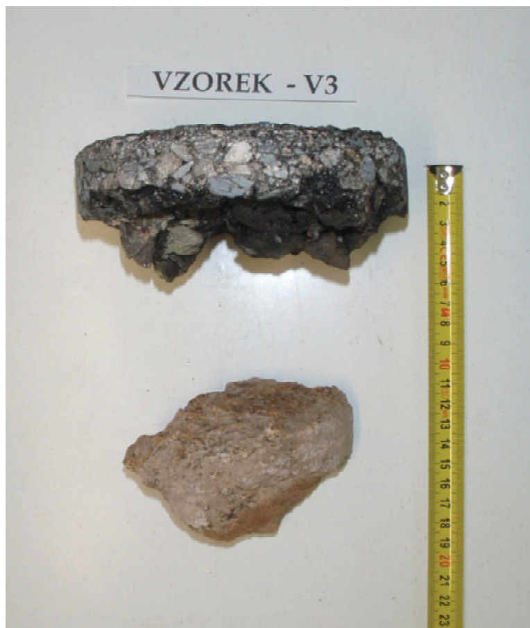
Obr. 6 - Jádro vývrtu Vzorek – V3 (laboratoř).
